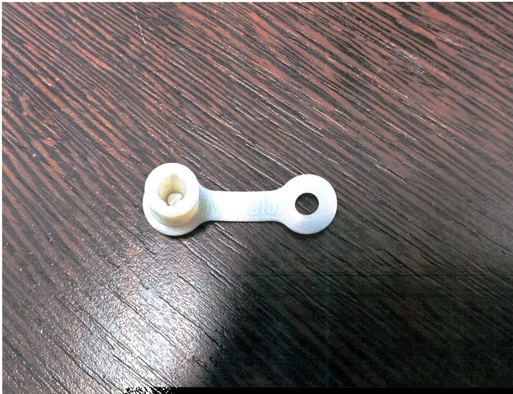
Рис. 23. Колпачок клапана дополнительной подачи воды (MAJ-215)
