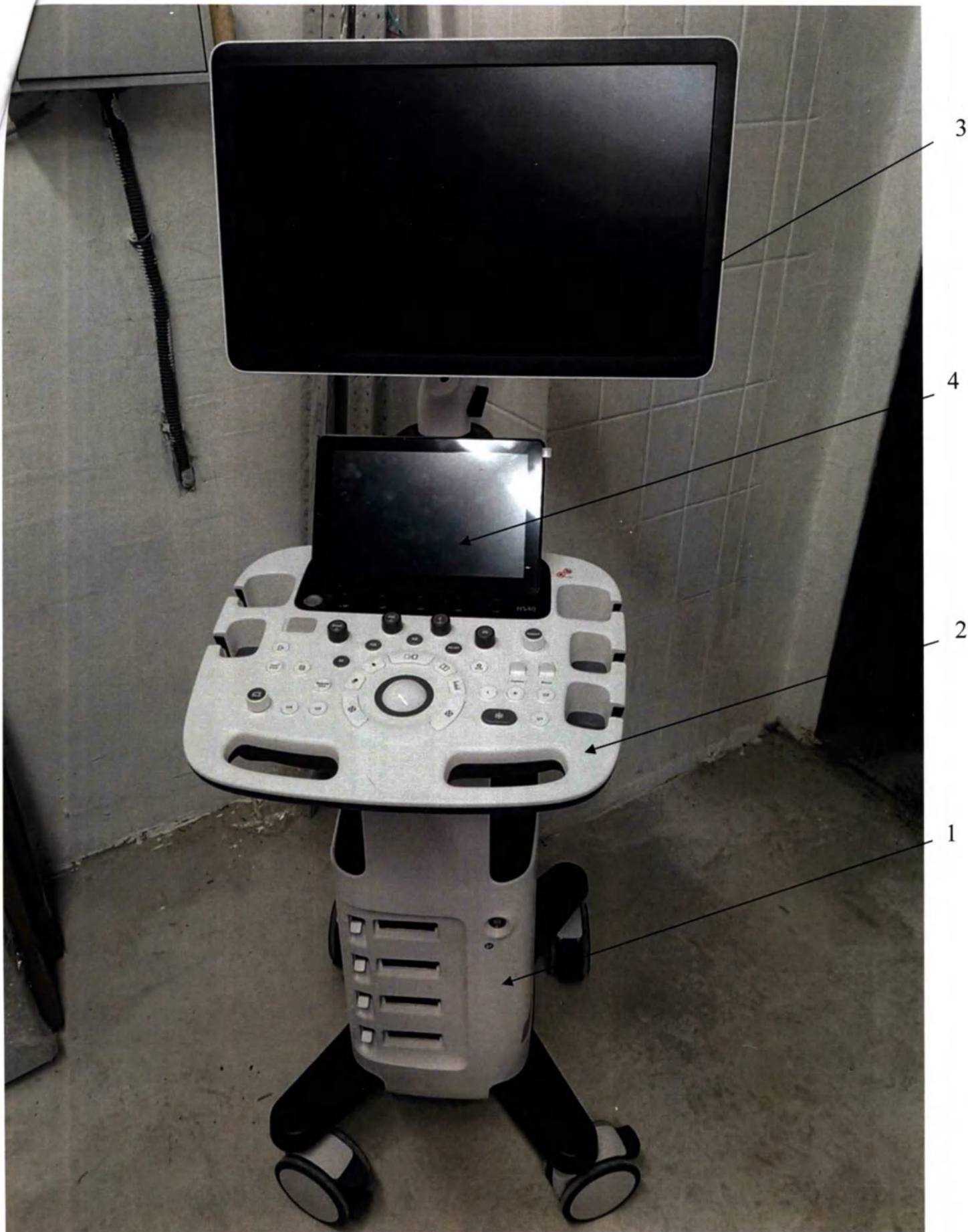
1. Консоль электронная, 2. Панель управления, 3. Специальный LED монитор, 4. Панель сенсорная.
