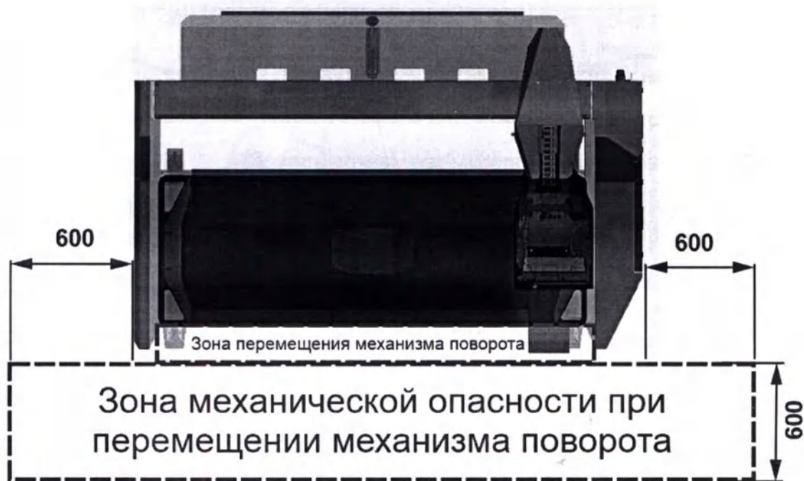
Рисунок 2.3 – Зона механической опасности при перемещении механизма поворота (вид сверху)
