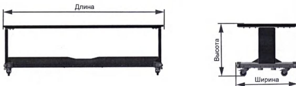
Рисунок 7.2 – Габаритные размеры стола / стола подъемного
