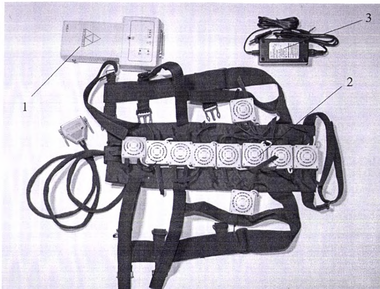
Рисунок 4 – Аппарат матричный для неинвазивного терапевтического воздействия оптическим излучением на внутренние органы и ткани Elmedlife В, где: 1 - Блок управления LBM; 2 - Жилет-гарнитура Elmedlife В; 3 - Зарядное устройство
