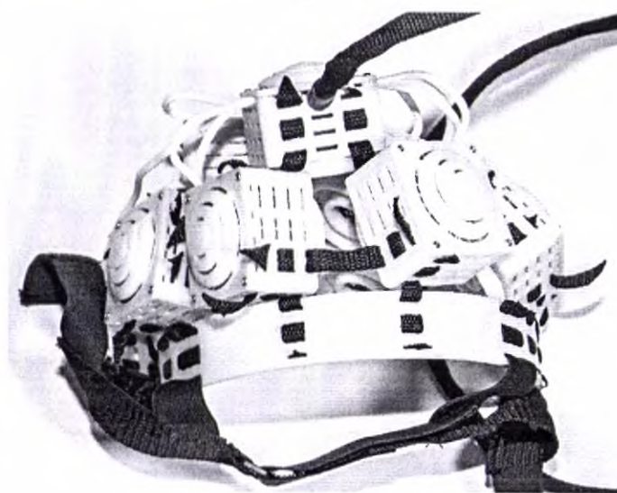
Рисунок 6 – Шлем-гарнитура Elmedlife Н, где: а – Вид спереди; б – Вид сзади: 1 – Коммутационный модуль (1 шт.); 2 - Световые модули с красными светодиодами (2 шт.); 3 – Световые модули с инфракрасными светодиодами (8 шт.); 4 - Стяжные ремни; 5 - Кабель соединительный с разъемом для подключения к блоку управления Н
