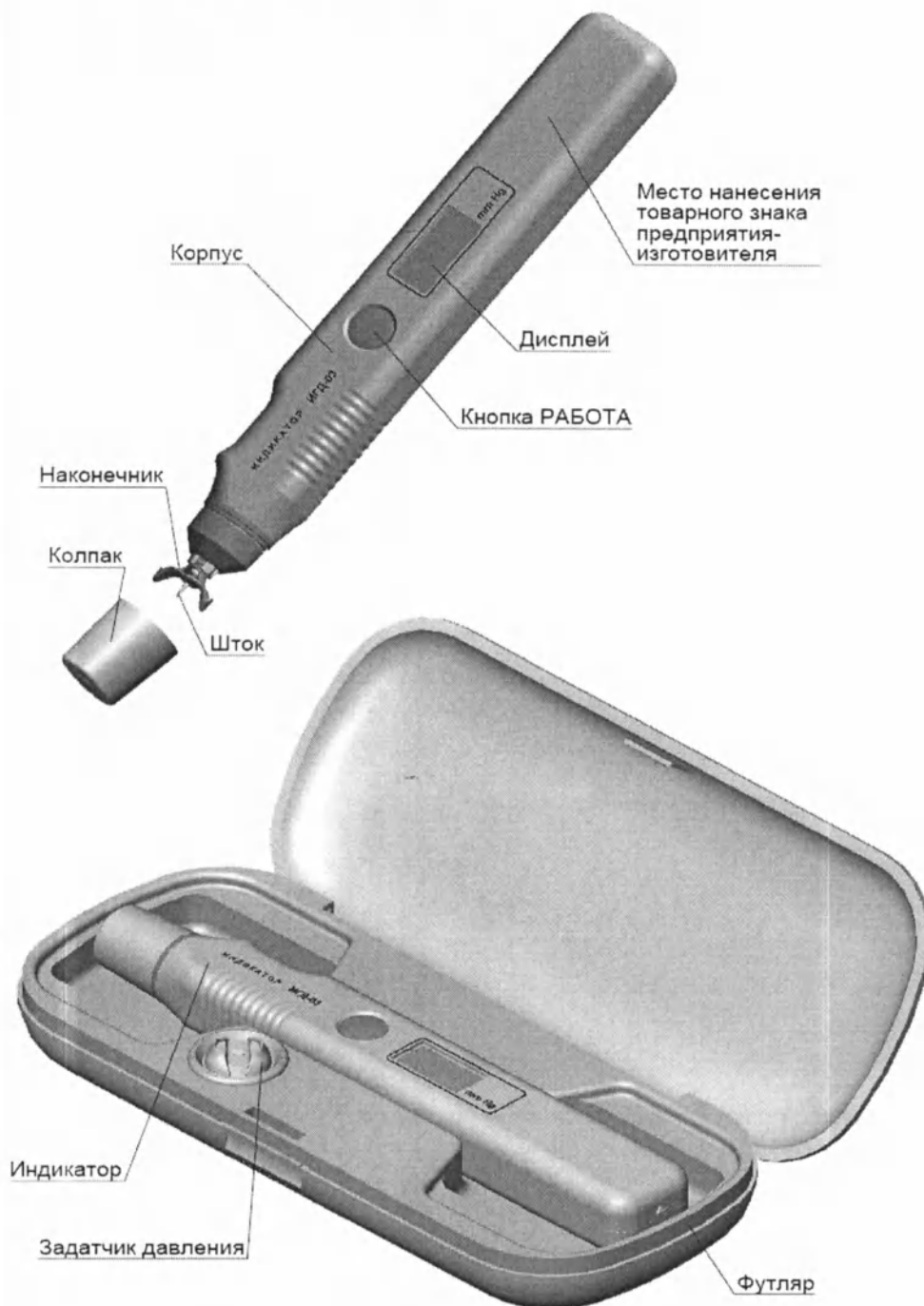
Рисунок 1 – Внешний вид индикатора ИГД-03
