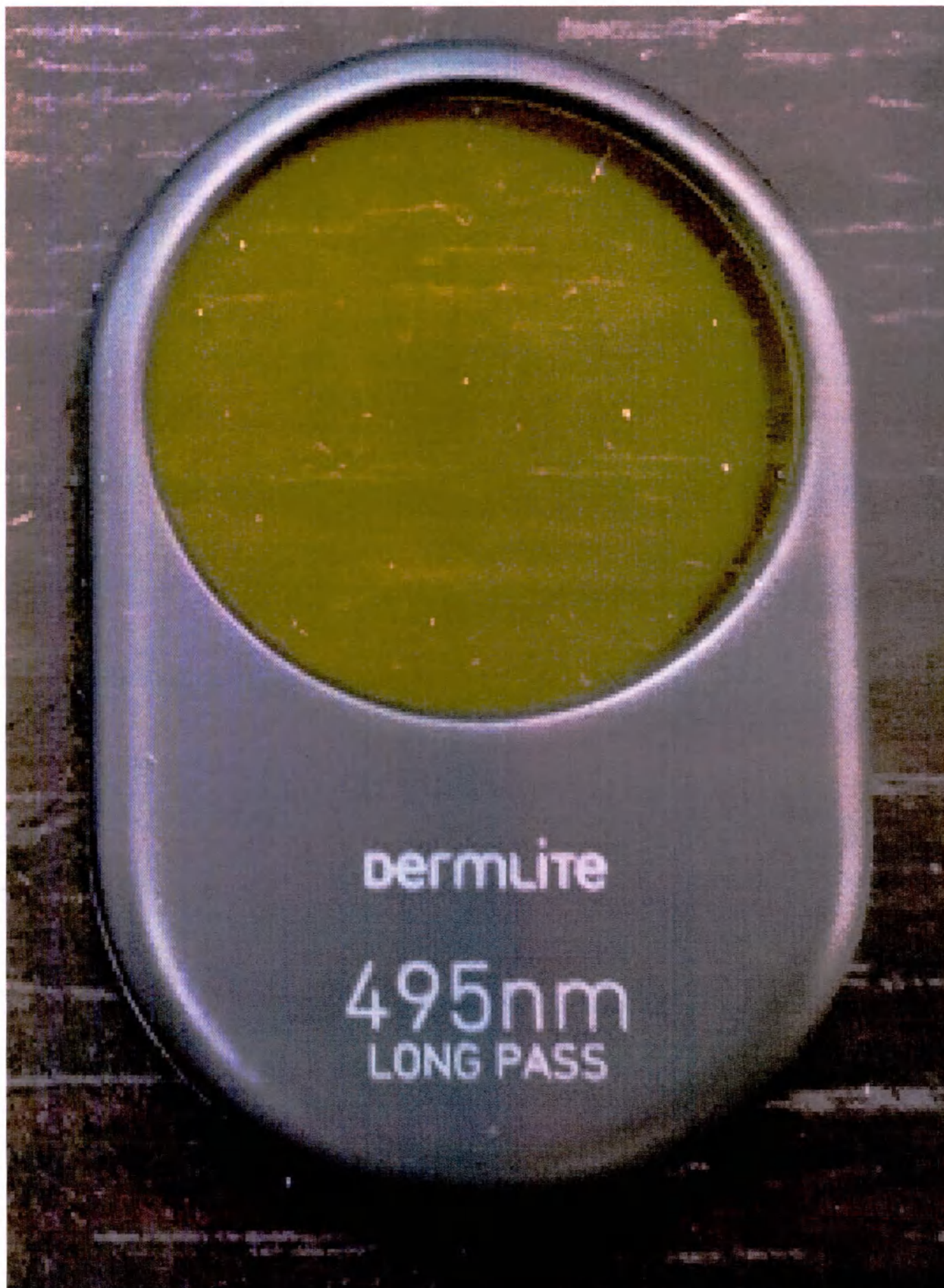
2. 495-нм дополнительный полосовой фильтр.
