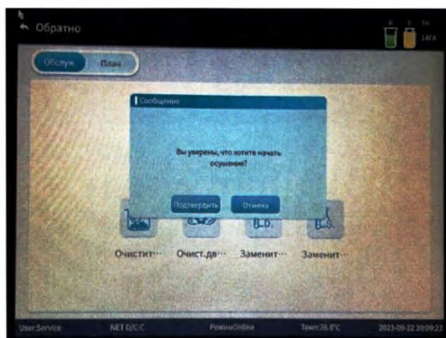
Запуск процедуры осушения жидкостной системы
