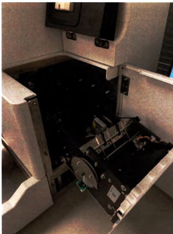
Откинутая вправо зона обнаружения, перемещения и подачи тест-полосок
