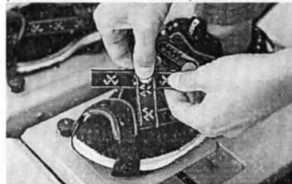
г) Соединение боковых ремней
