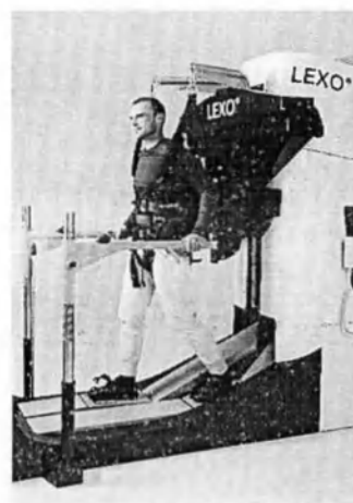
з) Использование тренажера для восстановления навыков ходьбы с системой ремней
