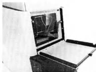
б) Отсек с рукоятью и резьбой для рукояти для аварийного спуска пациента
