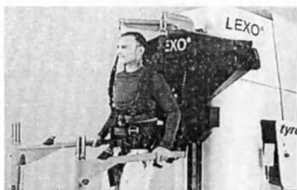
д) Регулировка поручней и фиксация пациента с помощью подушки для стабилизации таза
