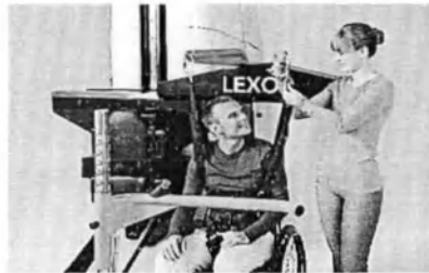
б) Размещение подвесных ремней на крючке подвеса для ремней.
