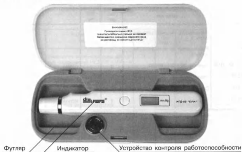
Рисунок 1 — Внешний вид индикатора в футляре
