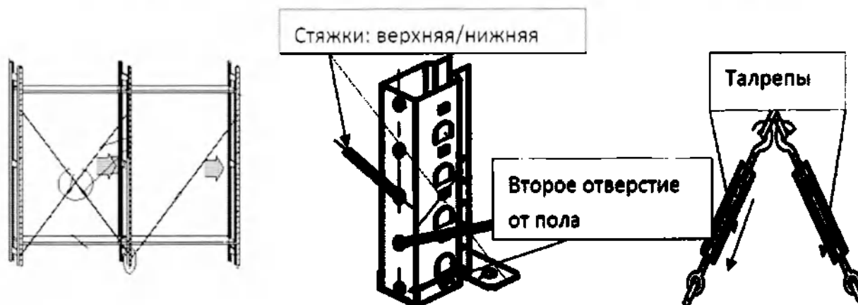
Рисунок 14 – Установка стяжек на стеллажи серии МД СК (МД СКУ)
