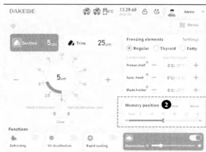
Рисунок 7–16-2. Индикатор положения держателя образца на главном интерфейсе
