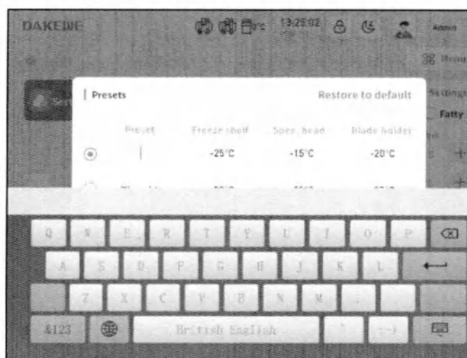
Рисунок 7–13. Ввод названия набора предустановленных значений температур при помощи виртуальной клавиатуры
