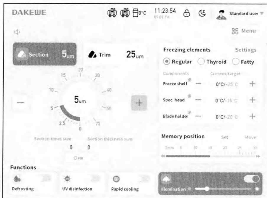
Рисунок 7–10. Интерфейс при аномальной температуре держателя образца
