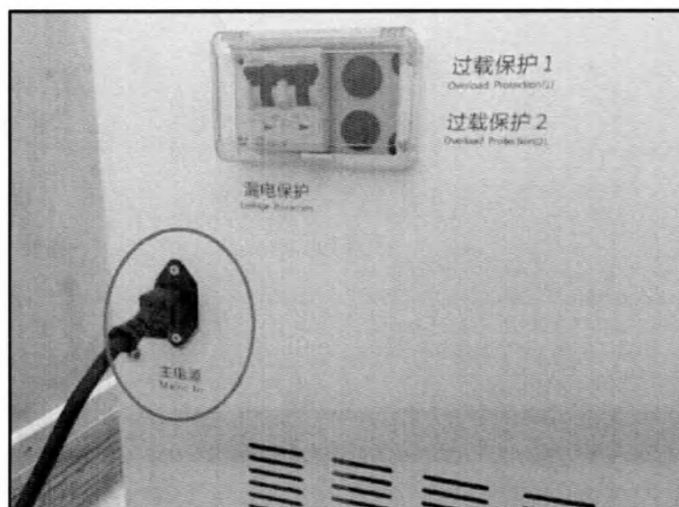
Рисунок 6–7. Подключение сетевого шнура
