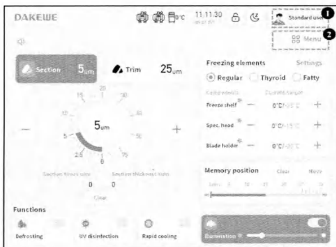
Рисунок 7-3. Смена пользователя - шаг 1 - кнопка «обычный пользователь» 2 – кнопка «Меню»
