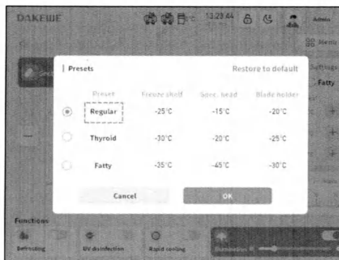
Рисунок 7–12. Область ввода названия набора предустановленных значений температур
