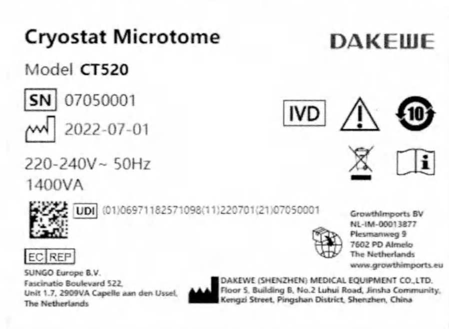
Рисунок 3-1. Маркировка Микротомы криостатического CT520 (Cryostat microtome CT520) с принадлежностями
