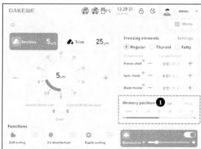
Рисунок 7–16-1. Индикатор положения держателя образца на главном интерфейсе
