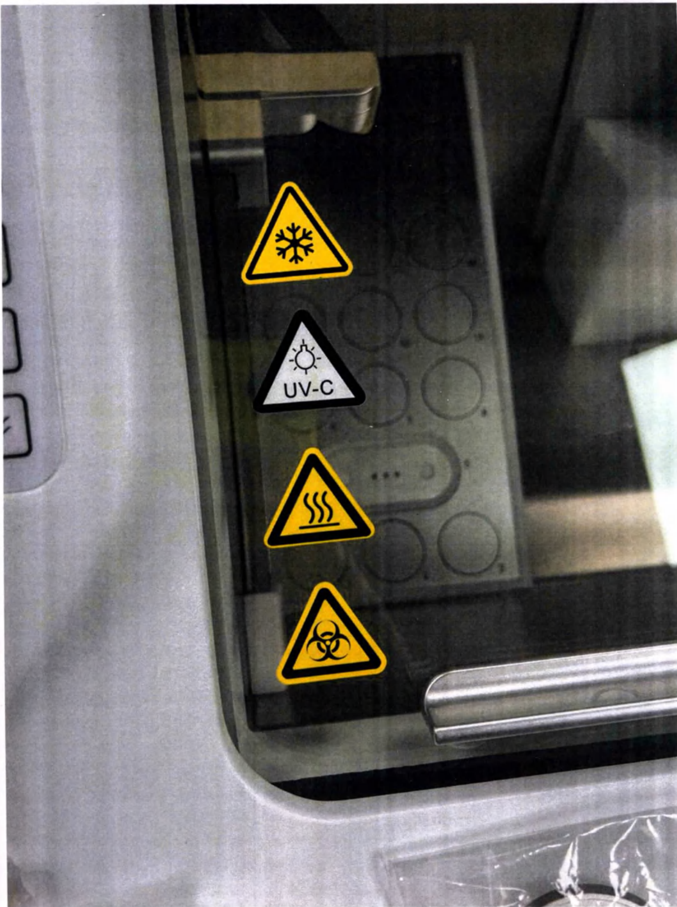
Рисунок 4. Изображение маркировки, расположенной на стеклянной дверце криокамеры
