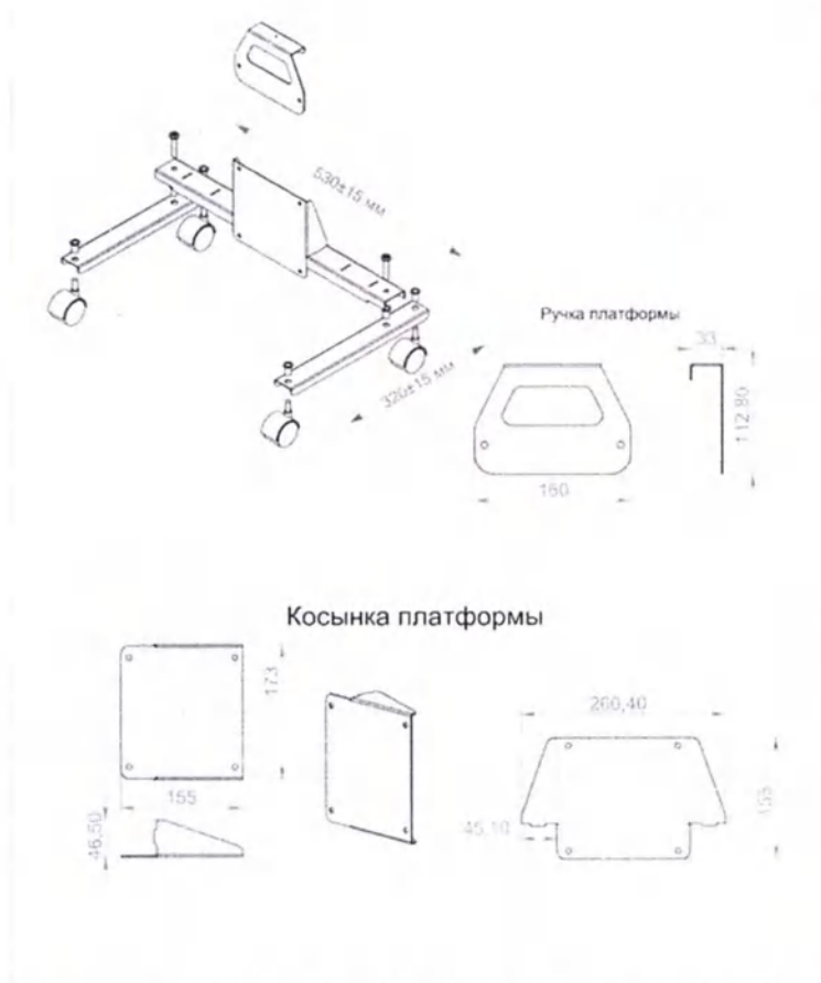
Рисунок 6 - Передвижная стойка с ручкой Арт. F1 в составе: стойка, ручка, болт М6х20 (6 шт.), производства ООО «Сфера Принт» для медицинского изделия: УФ облучатель: рециркулятор воздуха «Сфера» по ТУ 32.50.50-001- 67547475-2020 варианты исполнения: SR-15M, SR-30M, SR-45M, SR-30, SR-60
