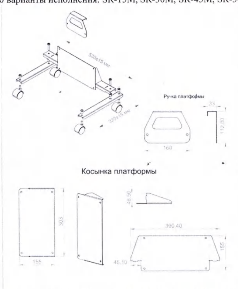
Рисунок 6 - Передвижная стойка с ручкой Арт. F1 в составе: стойка, ручка, болт М6х20 (6 шт.), производства ООО «Сфера Принт» для медицинского изделия: УФ облучатель: рециркулятор воздуха «Сфера» по ТУ 32.50.50-001- 67547475-2020 варианты исполнения: SR-15M, SR-30M, SR-45M, SR-30, SR-60
