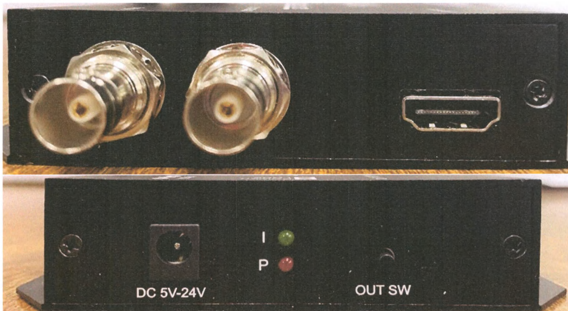
Переходник для подключения видеокольпоскопа к монитору для камеры со встроенным источником света и дисплеем, модель F
