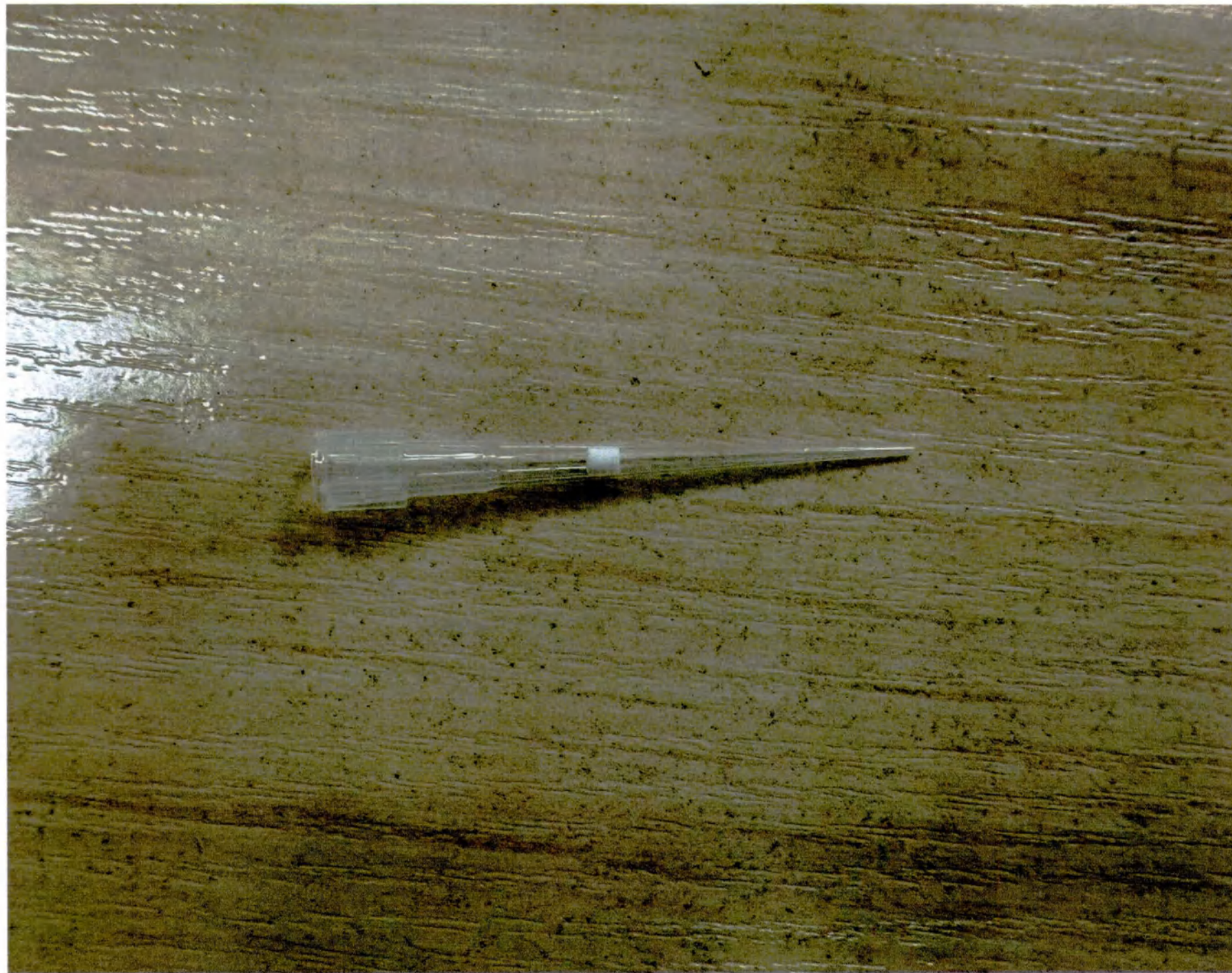
Фотографическое изображение №11.2. Наконечники универсальные 10 мкл с фильтром, удлиненные тип N, нестерильные, в штативе, 96 шт. (наконечник, крупный план)
