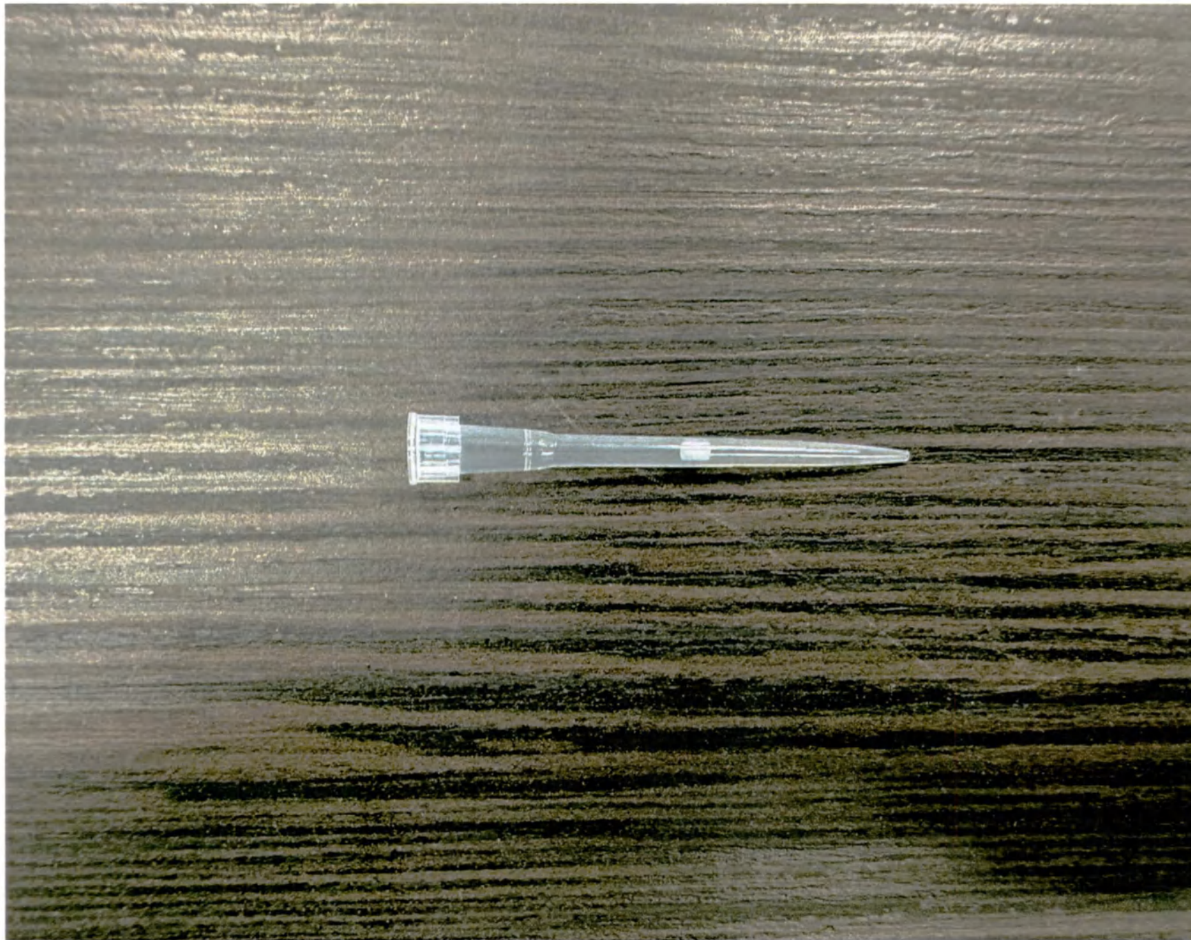
Фотографическое изображение №17.2. Наконечники универсальные 10 мкл с фильтром, удлиненные тип L, нестерильные, в штативе, 96 шт. (наконечник, крупный план)
