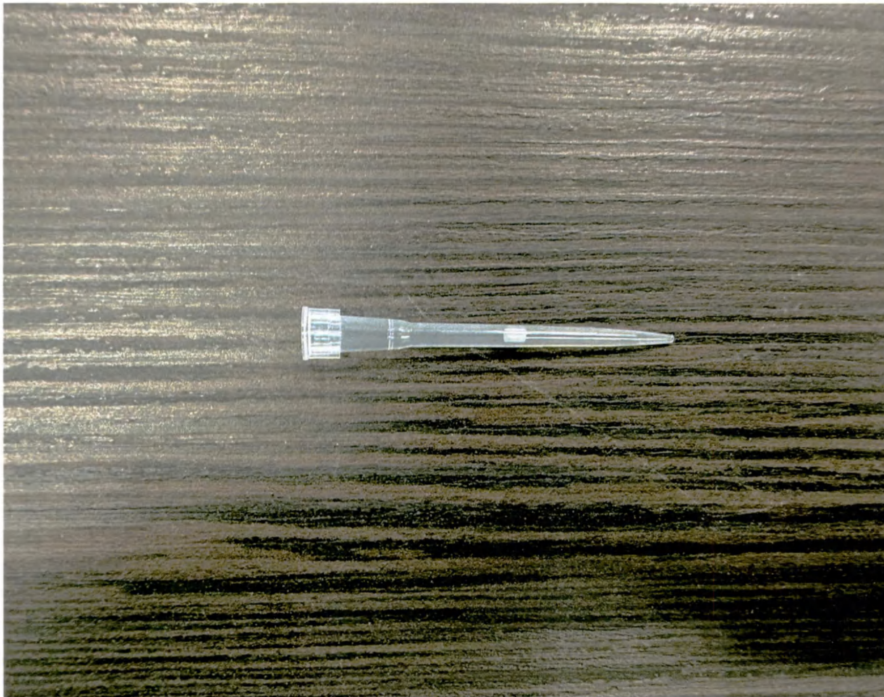
Фотографическое изображение №18.2. Наконечники универсальные 10 мкл с фильтром, удлиненные тип L, нестерильные, в сменных блоках, 960 шт. (наконечник, крупный план)
