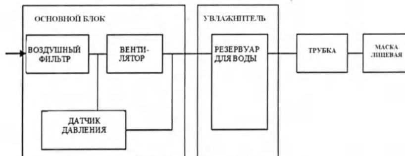
Рисунок 12-1. Принципиальная схема работы изделия
