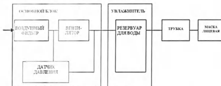
Рисунок 15-1. Принципиальная схема работы изделия
