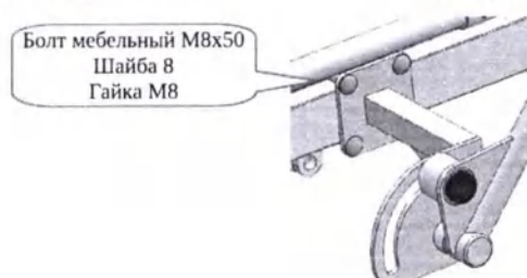
Рисунок Б4. Установка бокового ограждения
