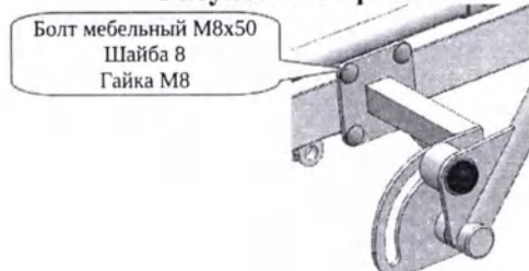
Рисунок Б2. Установка бокового ограждения
