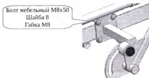
Рисунок Б4. Установка бокового ограждения
