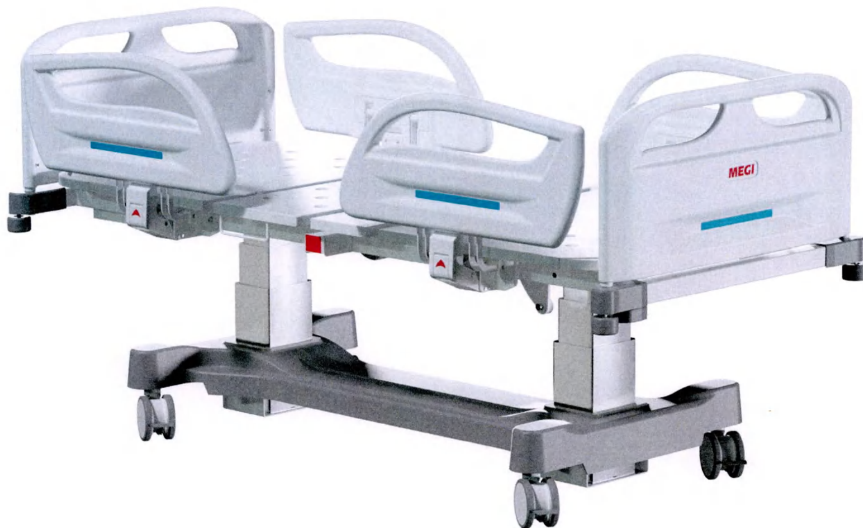
MEGI Meli 2 Кровать медицинская функциональная с регулированием высоты электроприводами колонного типа, пластиковыми спинками, пластиковыми боковыми ограждениями, ложем из стального листа, регулированием секций и Тренделенбурга электроприводами
