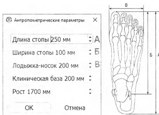
Рис. 4.4. Ввод антропометрических параметров пациента: слева – окно ввода параметров, справа – схема определения параметров стопы
