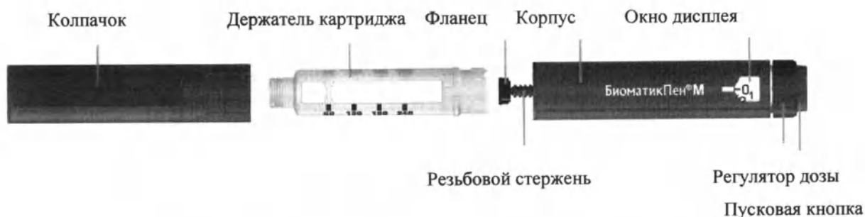
Рисунок 1. Внешний вид и составные части шприц-ручки
