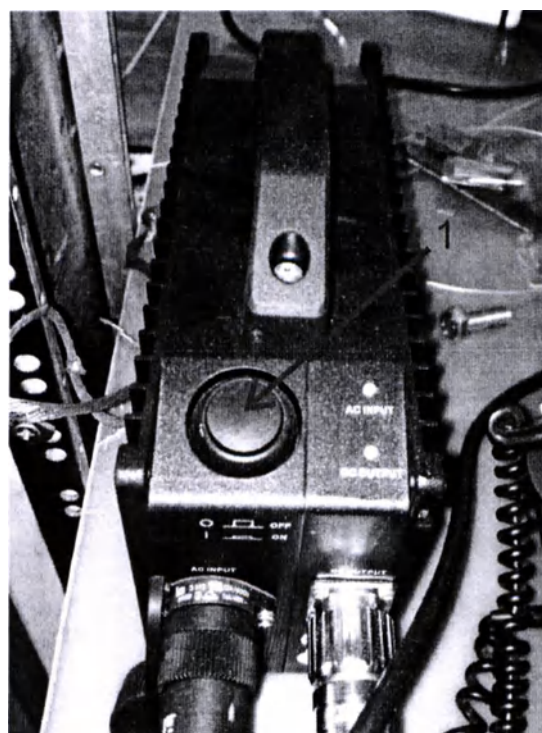
Рис. 3.18.2.2-2. Блок питания цифровой рентгеновской панели
