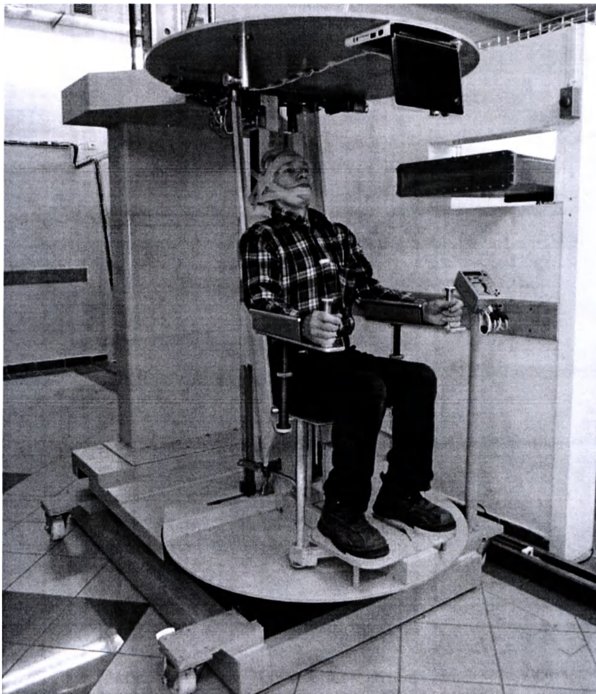
Рис. 3.17.2-5 – Система позиционирования пациента сидя
