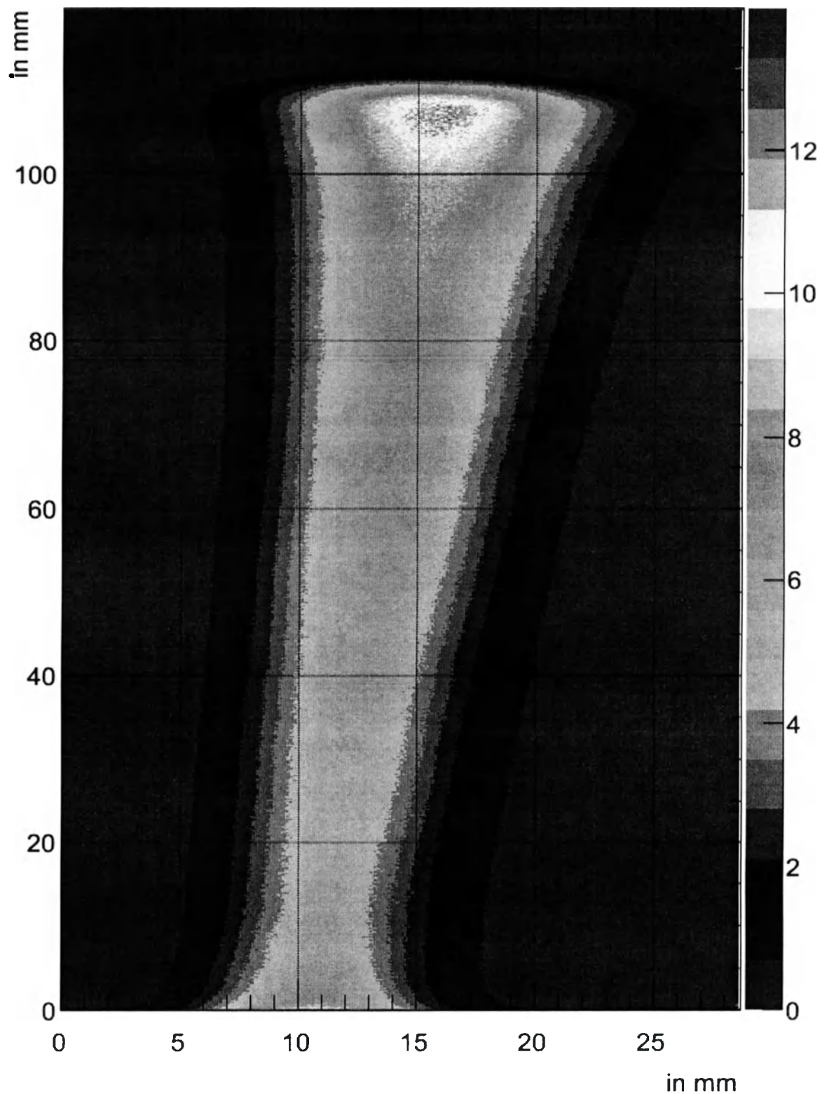
Рис. 3.16-3. Распределение дозного поля в виде цветовой двухмерной гистограммы
