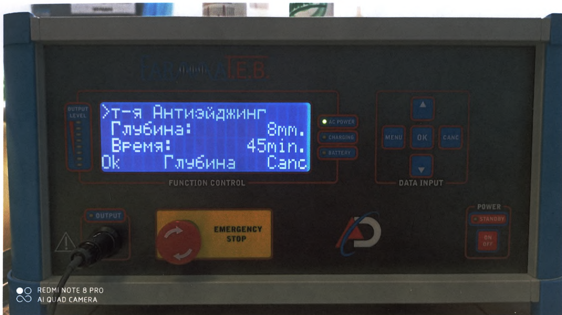
Передняя панель. Органы управления и кнопка аварийной остановки «Emergency stop». Необходимые надписи и символы находятся на передней панели.
