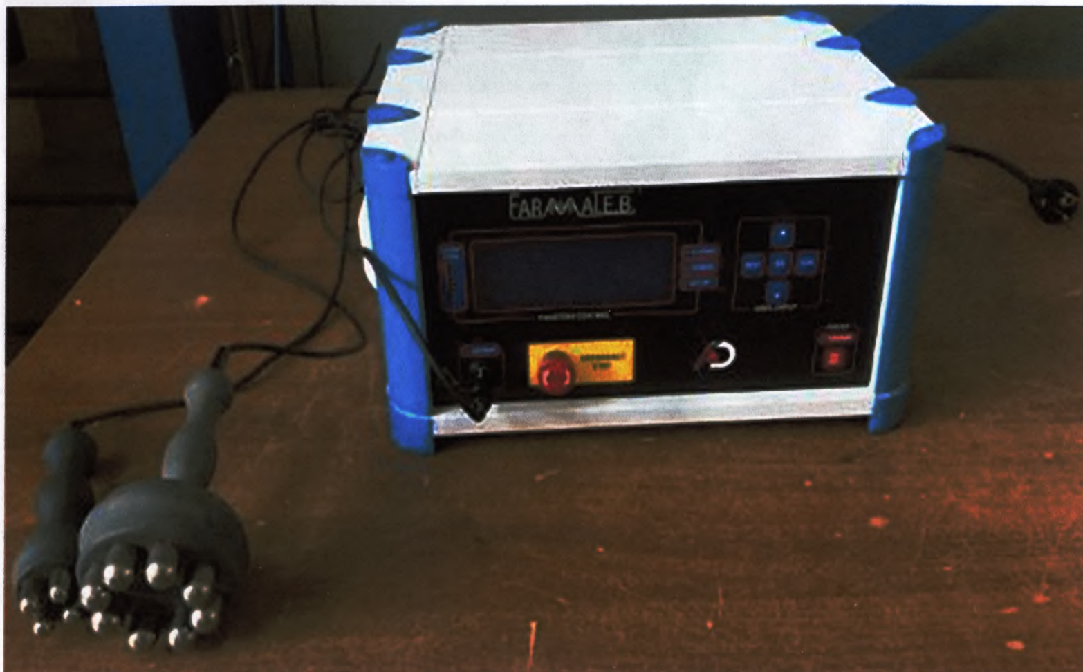
Внешний вид основного блока с кабелем питания и активными электродами - ручки с 4-х и 8-контактной головкой
