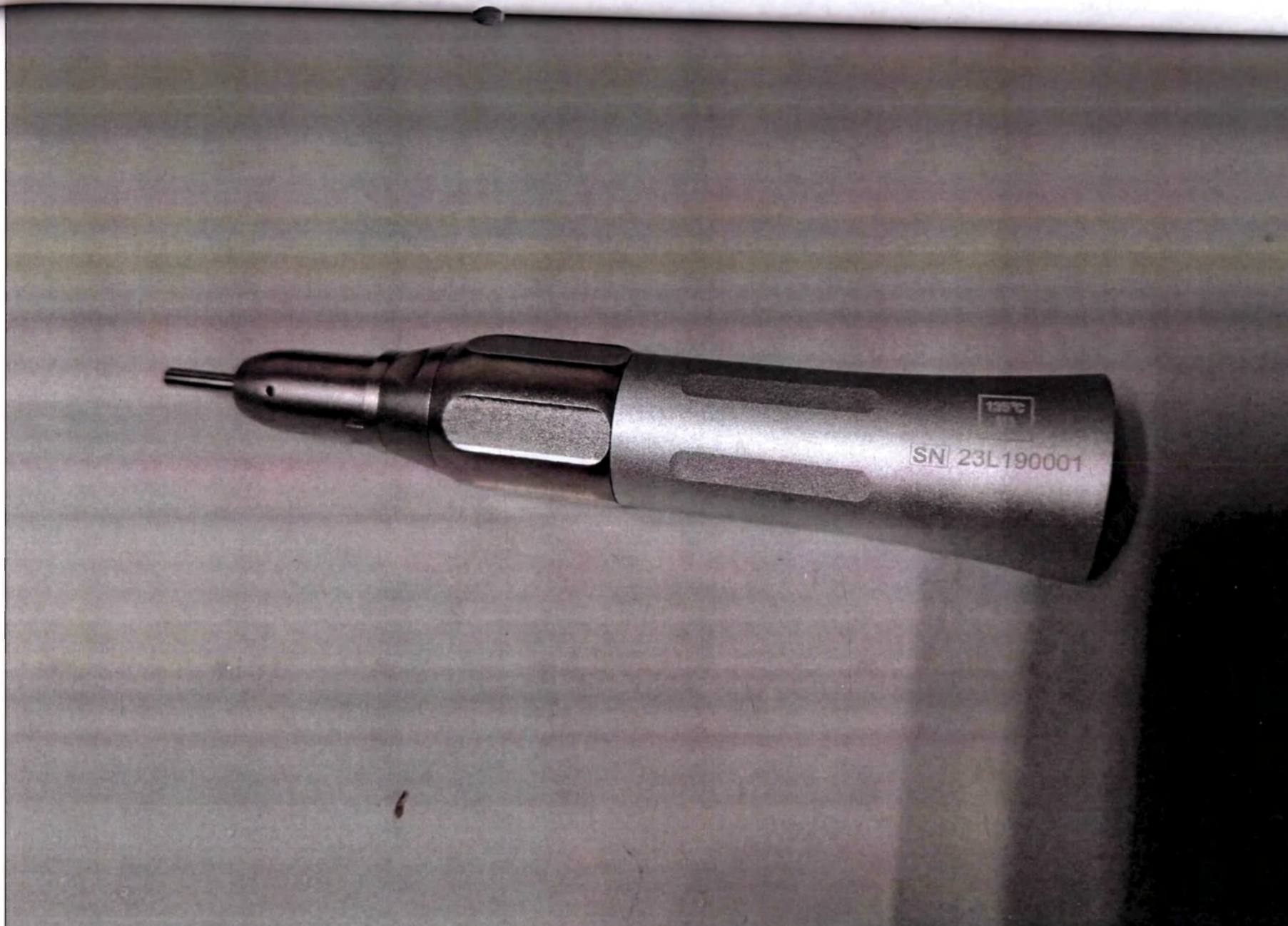
Рис. 15. Наконечник стоматологический прямой DE01 с тестовым мандреном
