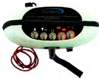
Рисунок 3.37 – Функция экстренной остановки системы (красный шнур блока подъемного)
