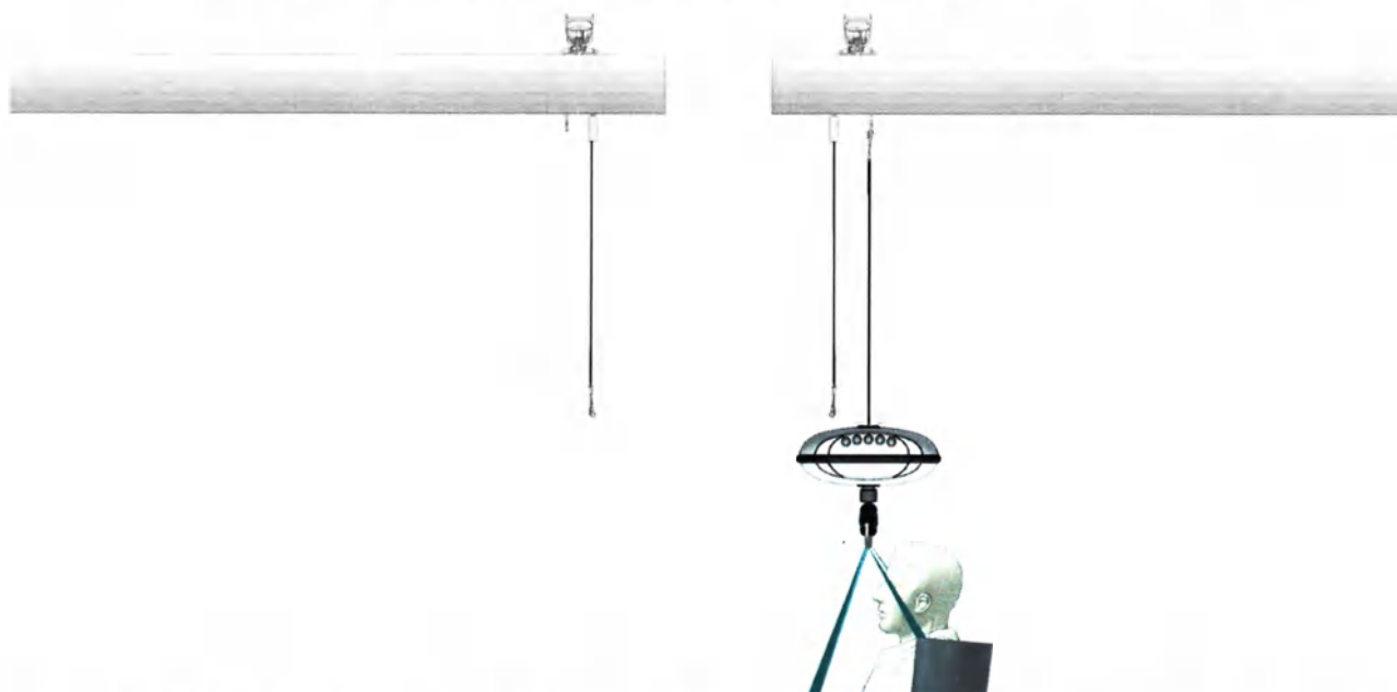
Рисунок 3.15 – Отсоединение ремня «рум-ту-рум» от блока подъёмного для продолжения движения в помещении «Б»
