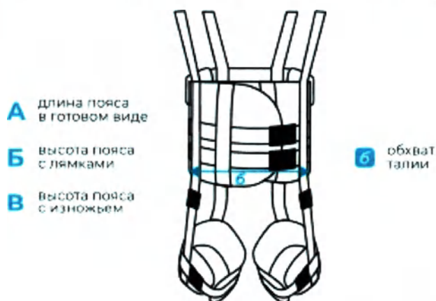
Рисунок 1. 102 – Пояс поддерживающий. Размерный ряд и схема определения размера Размеры даны в см. Длина строп корректируется по росту на шаг 7 см. в пределах каждого размера
