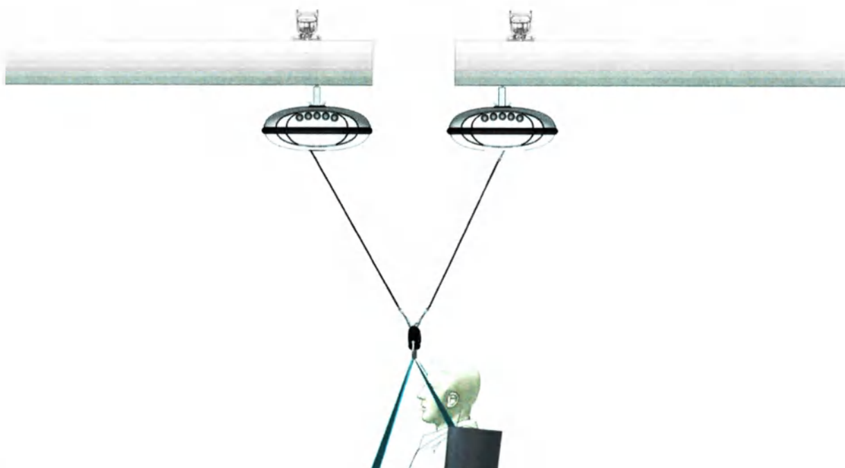
Рисунок 3.17 – Перенос ремня блока подъёмного на рельсу в помещении «Б»
