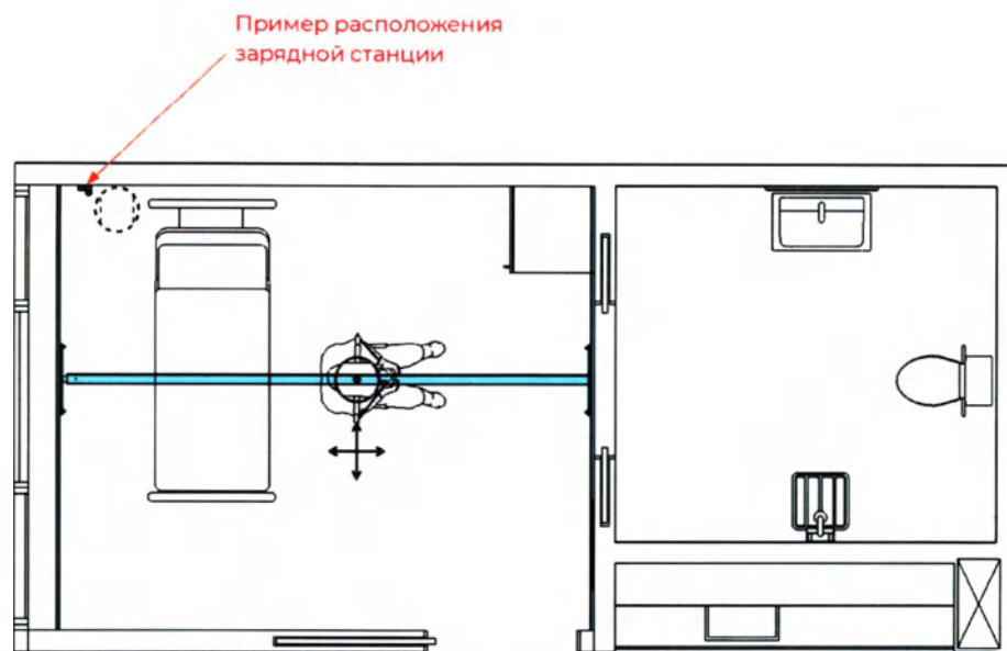
Рисунок 3.8 – Система для подъема и перемещения пациентов рельсовая (потолочная, настенная) медицинская «ОРТОРЕНТ ПРМ-01» (статическая). Примеры установки зарядной станции. Вариант 1
