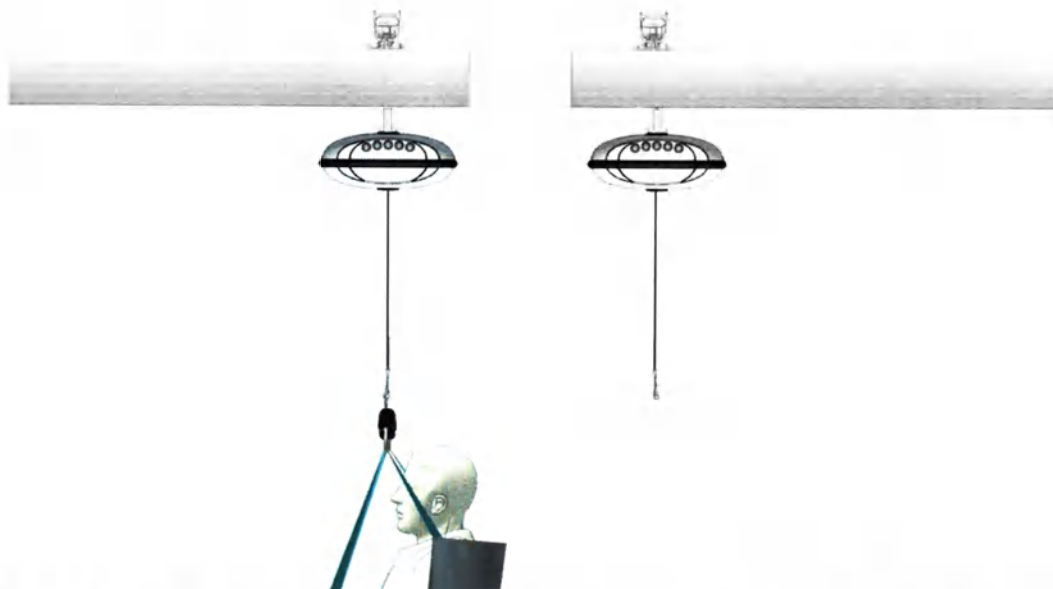
Рисунок 3.18 – Отсоединение ремня от блока подъёмного для продолжения движения в помещении «Б»
