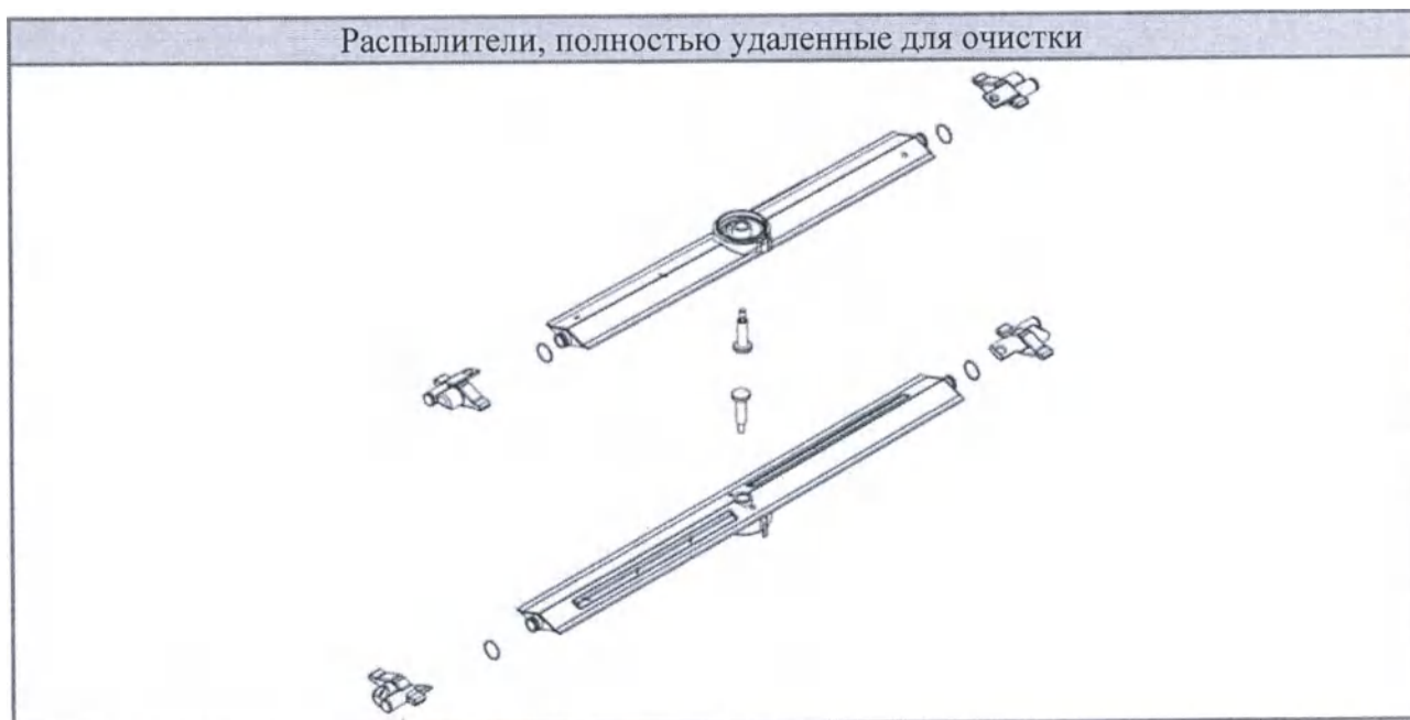
Рисунок 7 – Нижний распылитель устройства: периодически разбирать и очищать все распылители для поддержания эффективности очистки.
