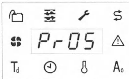
Рисунок 11 – В области индикации на передней панели: цифровое отображение в центре со светодиодными индикаторами по периметру
