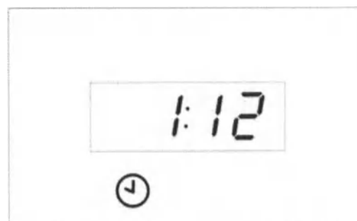
Рисунок 22 – После активации команды запуска цикла на дисплее чередуются индикация выбранной программы и времени, оставшегося до ее фактического запуска
