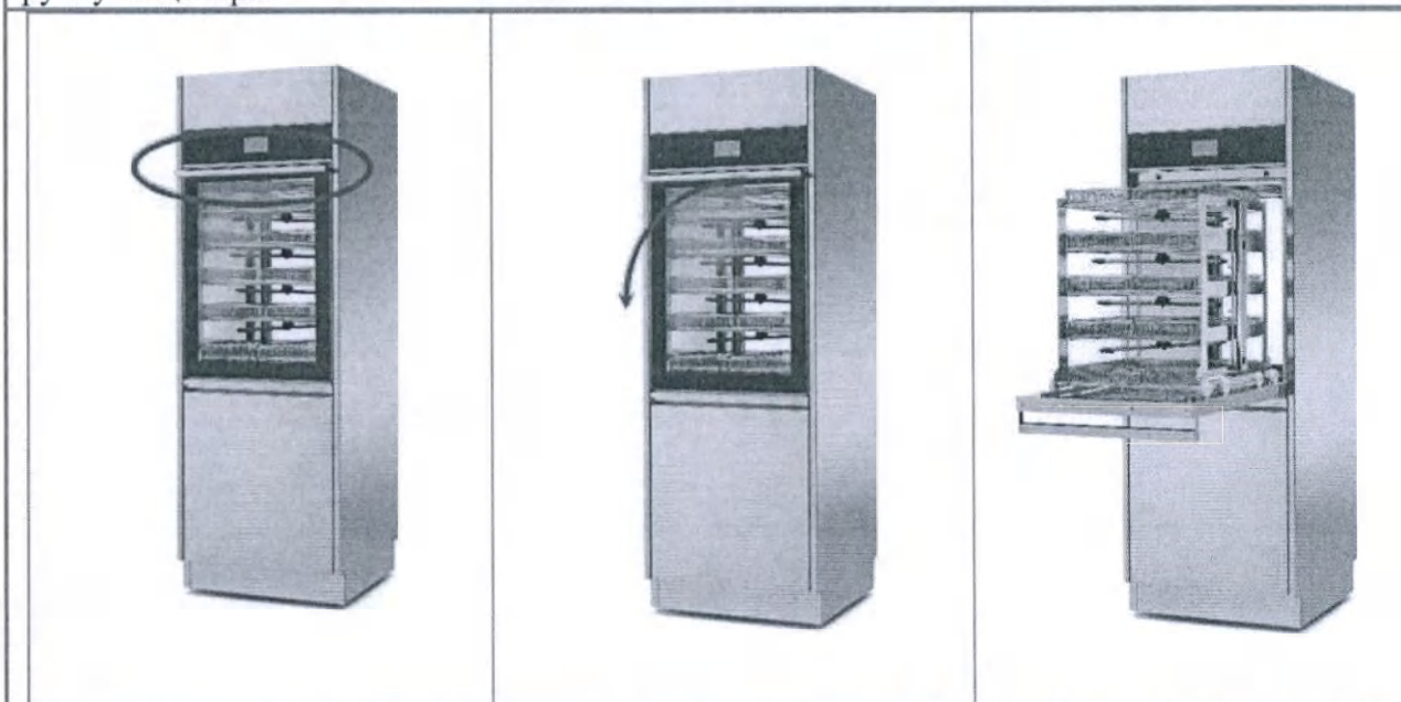
Рисунок 1 – Стеклопанель для доступа к моечной камере оснащена ручкой. Открытие вручную допускается только в том случае, если дверь не заблокирована, так как оснащена автоматическим двойным электрическим замком. Запрещается открывать дверь, если она заблокирована.
