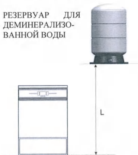
Рисунок 52 – Резервуар, работающий при нормальном давлении, высота над поверхностью установки машины
