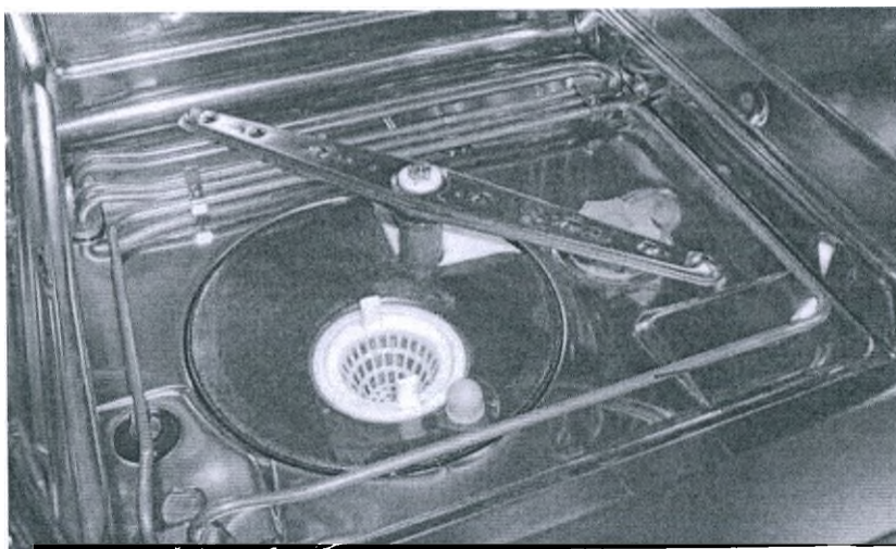
Рисунок 3 – Общий вид внутренней части камеры, детали нагревательных элементов
