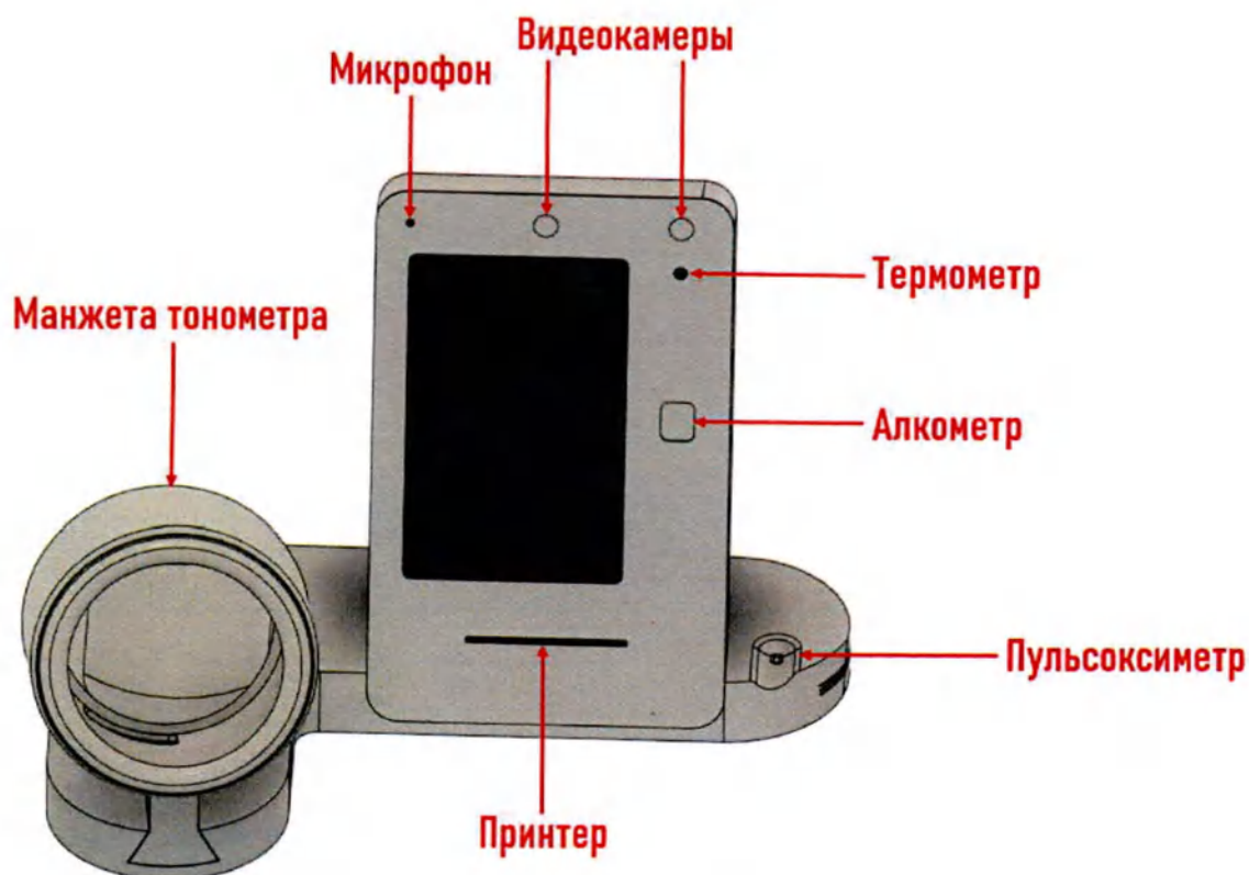
Рисунок 1 – Устройства, входящие в комплекс
