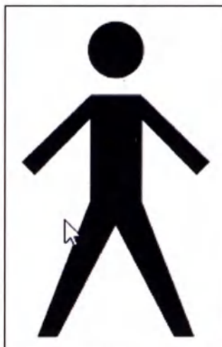
Рисунок 5 Макет маркировки рабочей части типа BF
