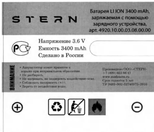
Рис.22. Макет маркировки Батареи LI ION 3400 mAh, заряжаемой с помощью зарядного устройства
