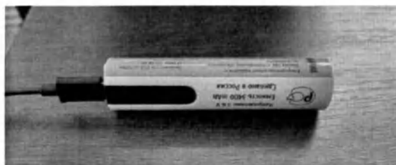
Рис.5. Зарядка аккумуляторной батареи
