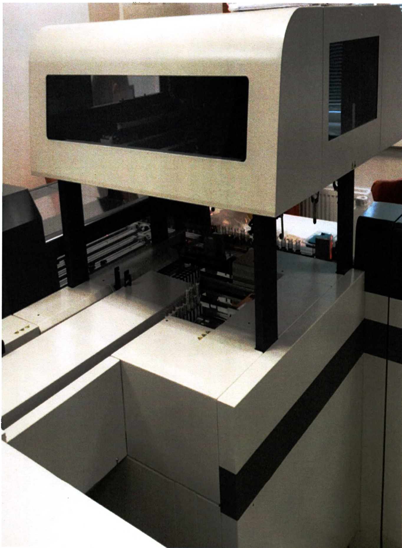
Рисунок 17. Линия для подключения приборов AU/DxC - AU/DxC Connection.
