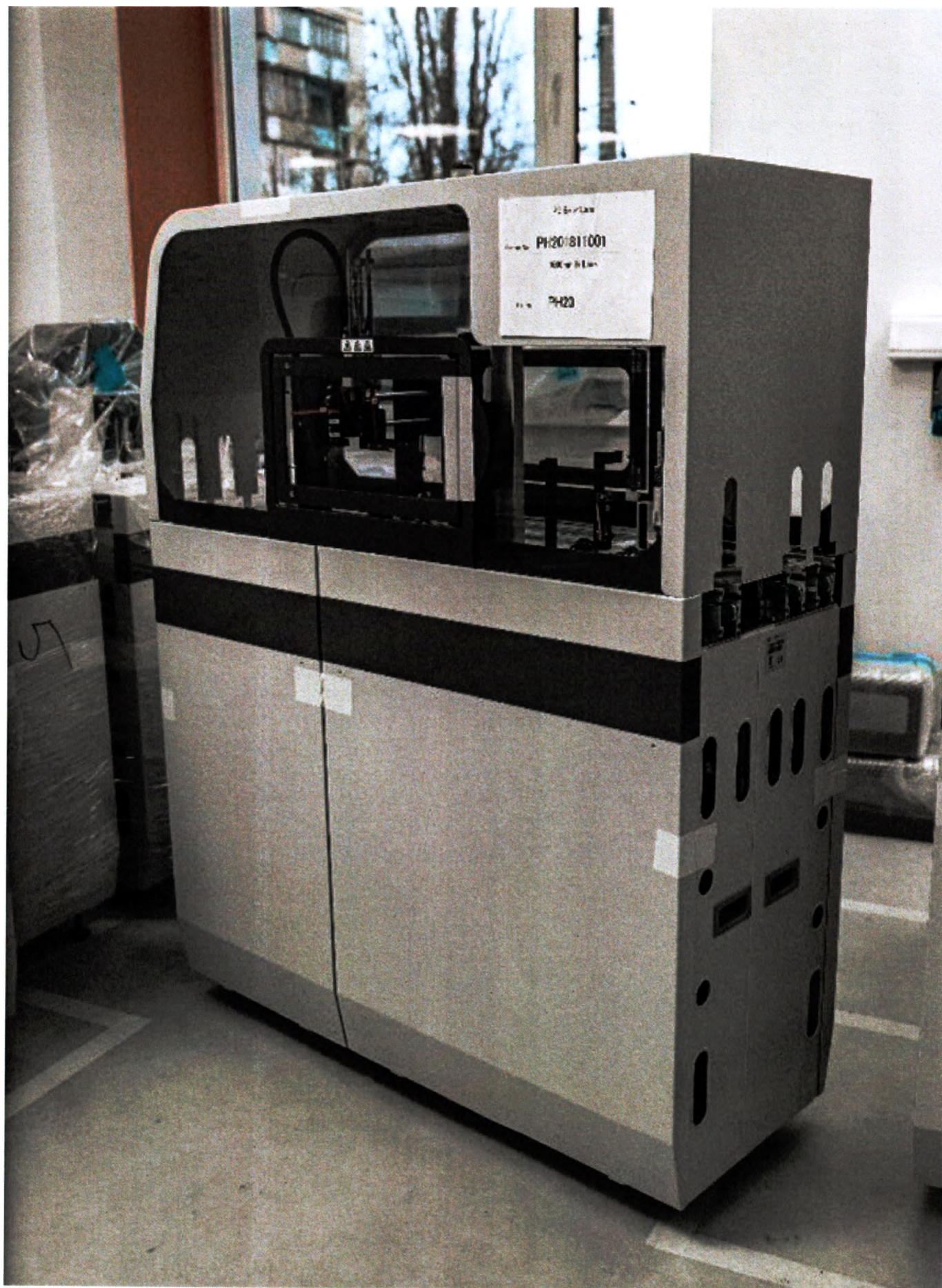
Рисунок 2. Модуль определения ошибок на линии Error Lane.
