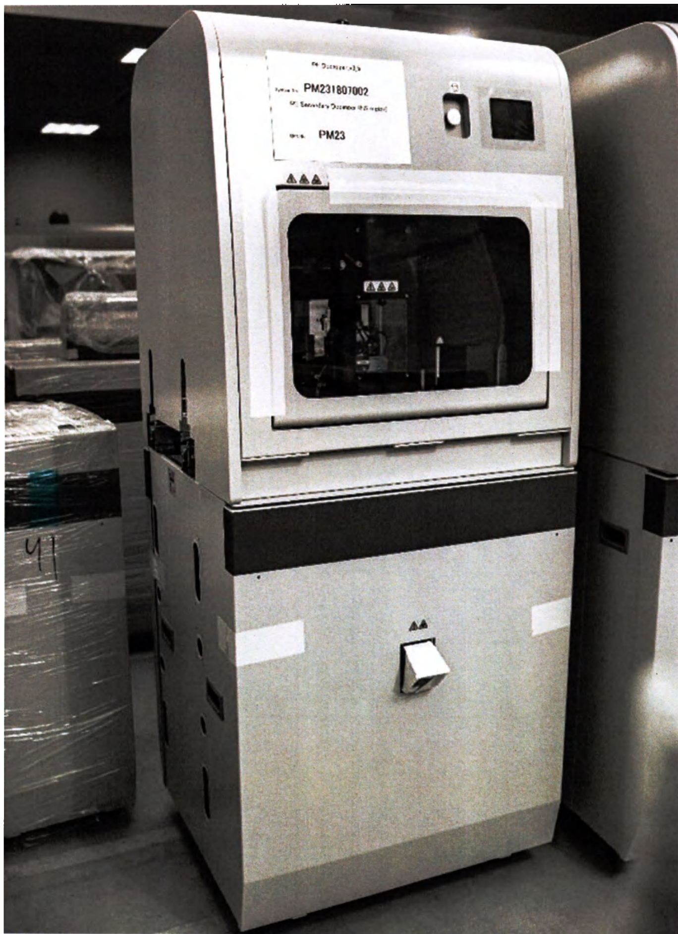
Рисунок 5. Модуль удаления крышек с пробирок, вторичный Secondary Decapper.
