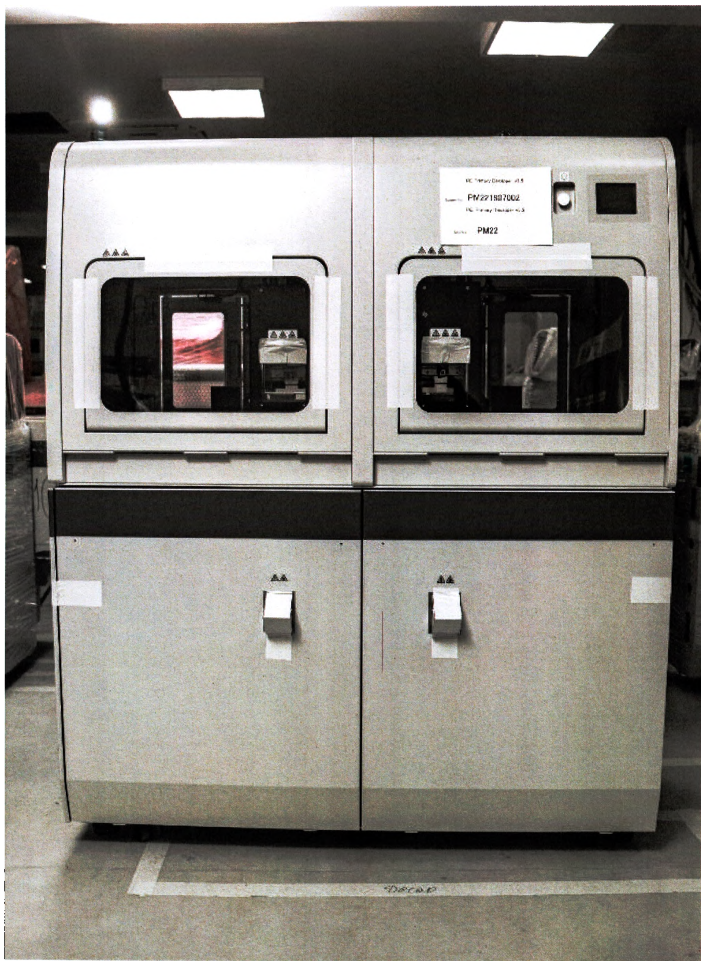
Рисунок 4. Модуль удаления крышек с пробирок, первичный Primary Decarper.
