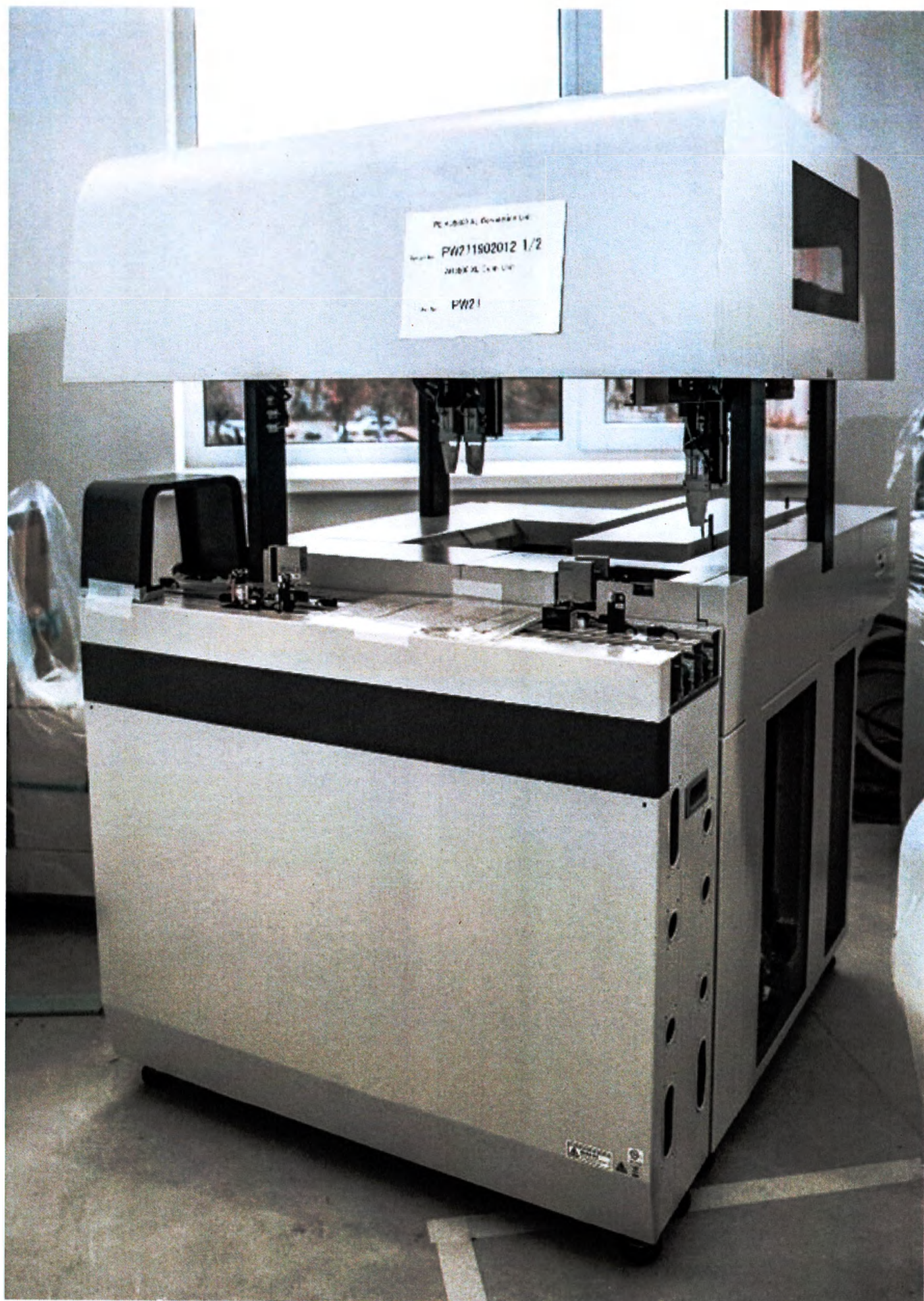
Рисунок 14. Модуль для подключения прибора AU 5800 и Крышка, линия подключения AU5800.
