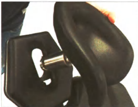
Рис. 6.6.1.A: Установка упора для головы
