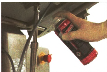
Рис. 8.3.1.А: Обработать цилиндр спреем
