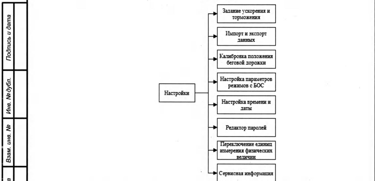
Рисунок 53 - Структурная схема меню управления беговой дорожки в режиме «Настройки»
