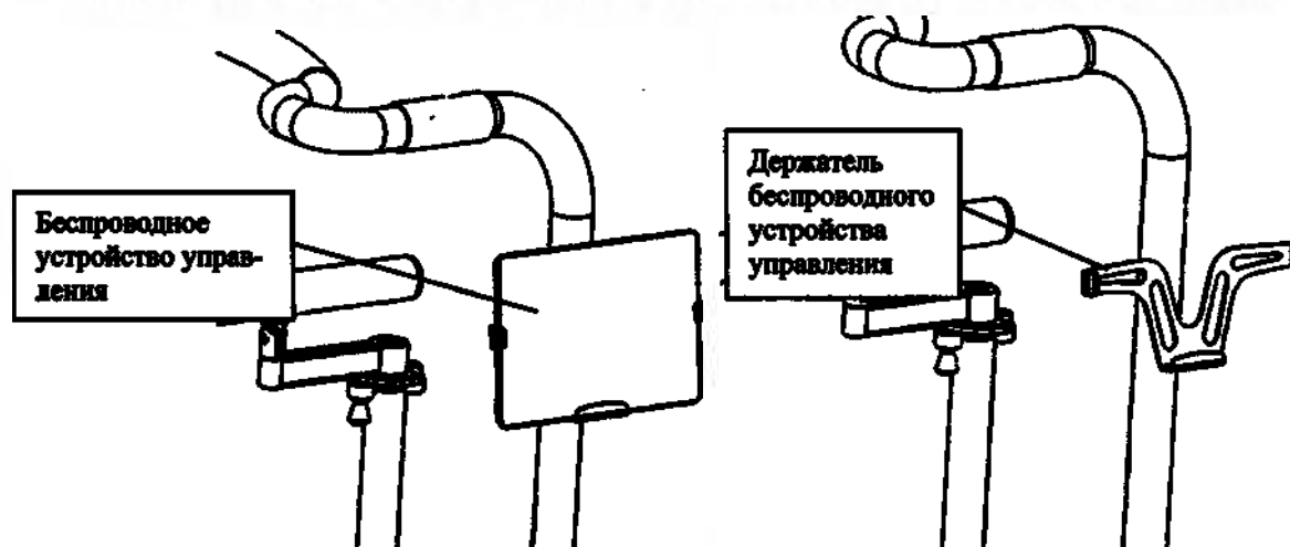
Рисунок 23 – Внешний вид установленного в держателе беспроводного устройства управления.
