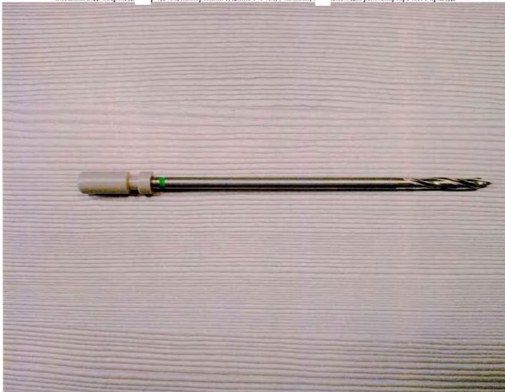
Внешний вид. Сверло, диаметр 4,2 мм, калиброванное, длина 145 мм, 3 канавки, с отверстием для рентгенопрозрачного привода
