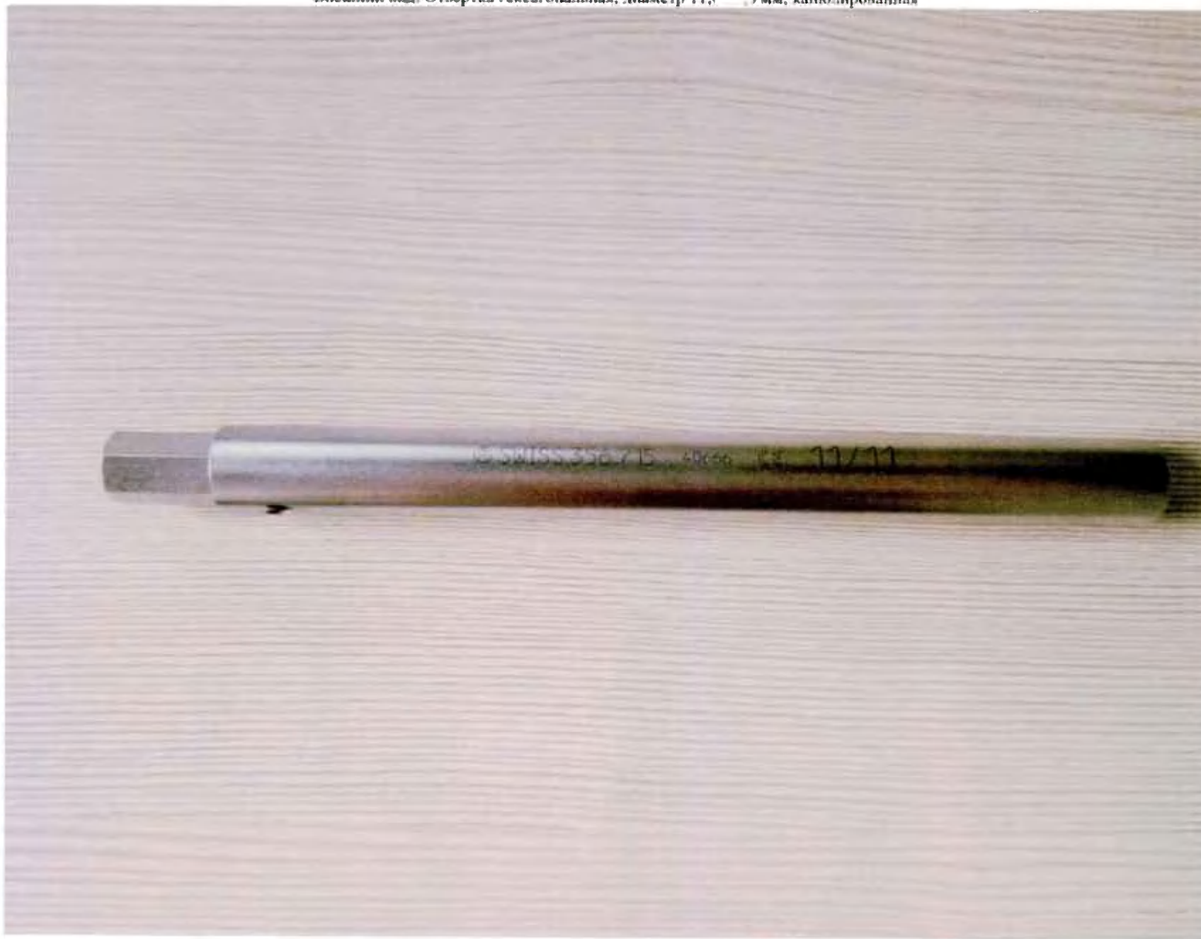
внешний вид. Отвертка гексагональная, диаметр 11,1 мм, канюлированная
