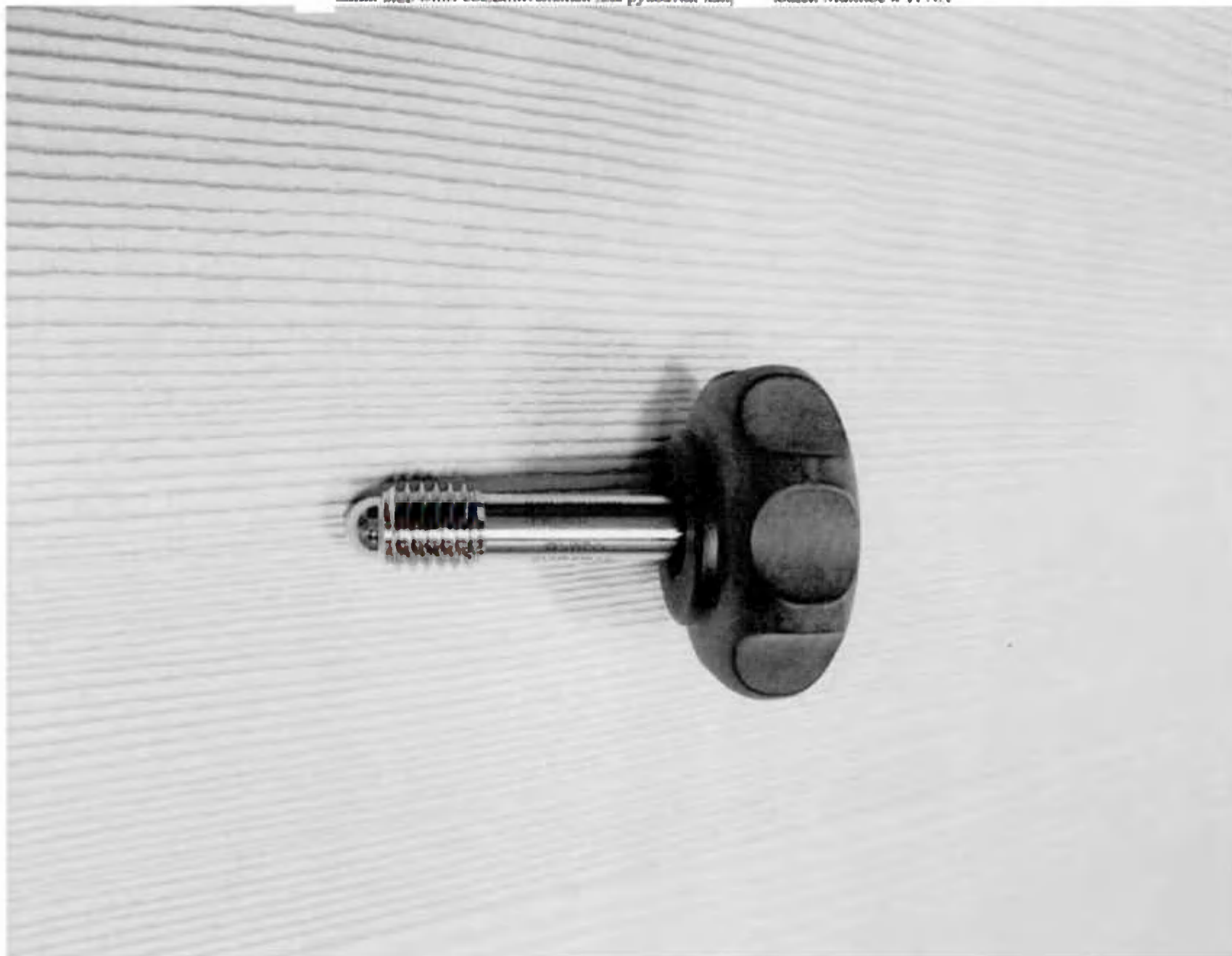
новый вид. Винт соединительный для рукоятки нап... ющей Multilos и TFNA
