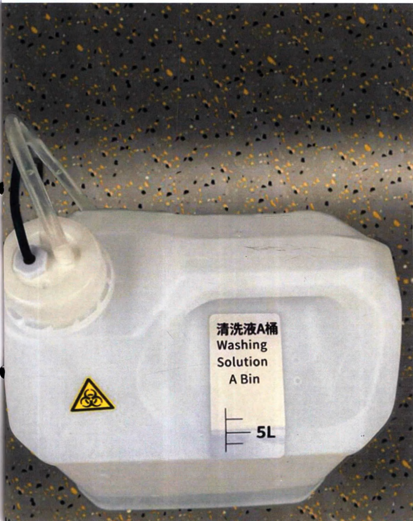
Канистра пластиковая для промывающего раствора с датчиком уровня и соединительной трубкой Washing Solution Bin 5л
