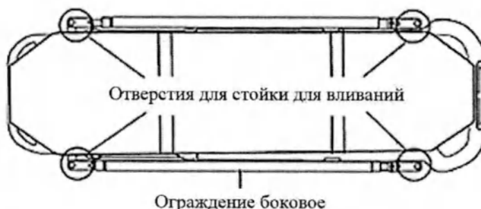
Расположение отверстий для стойки для вливаний на каркасе каталки (рамы). Вид сверху.
