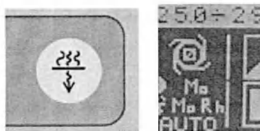
Рисунок 3.1.43 - Кнопка выбора и индикация на дисплее комбинации анод/фильтр
