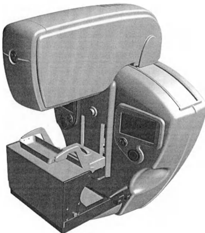
Рисунок А.4.4 - Конфигурация для съемки с увеличением
