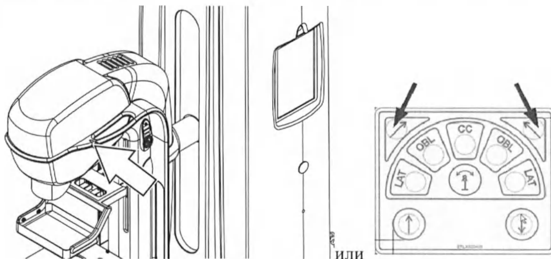
Рисунок 3.2.15 - Кнопки управления моторизированным поворотом штатива
