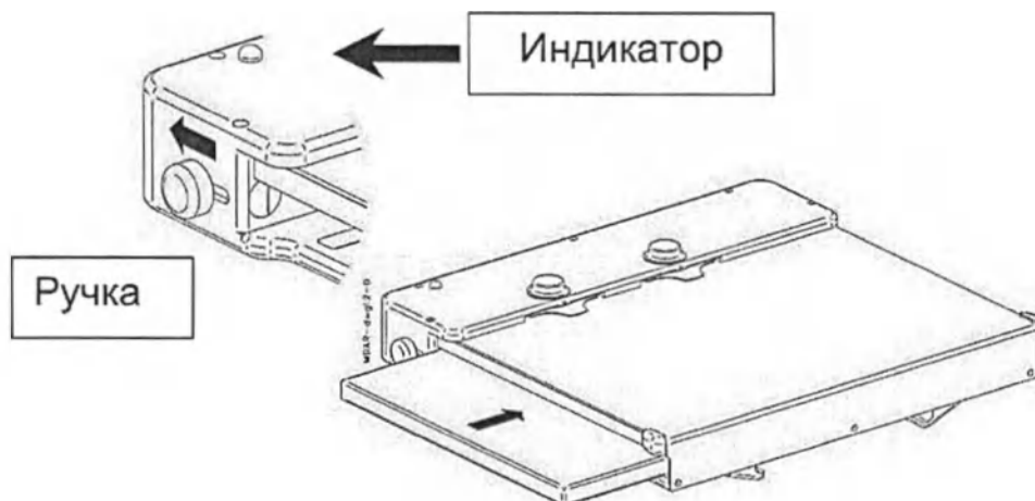
Рисунок 3.2.17 - Схема установки кассеты
