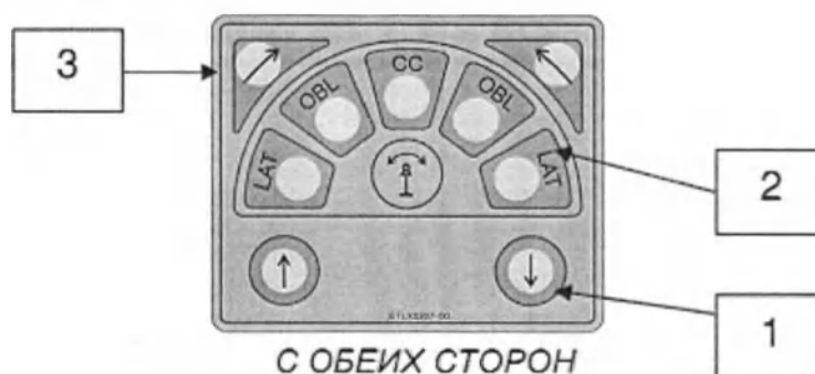
Рисунок 3.1.7 -Клавиатура движения С-дуги для версии моторизованного вращения
