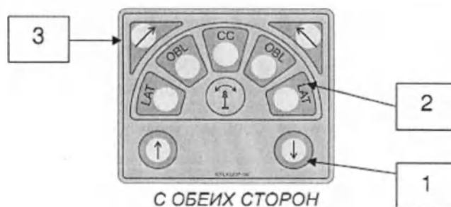
Рисунок 3.1.7 - Клавиатура движения С-дуги для версии моторизованного вращения
