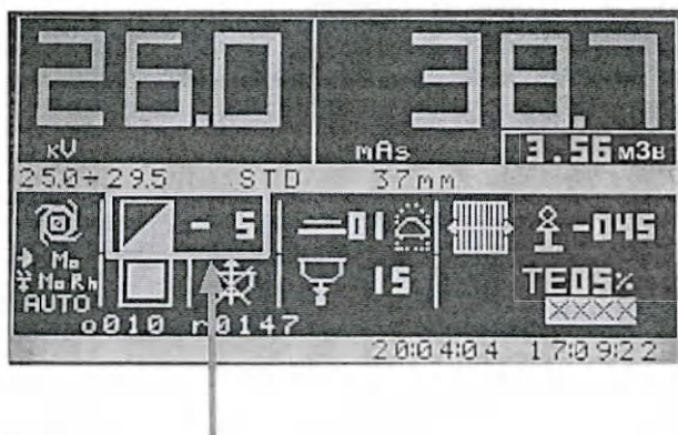
Рисунок 3.2.37 – Индикация плотности почернения снимка
