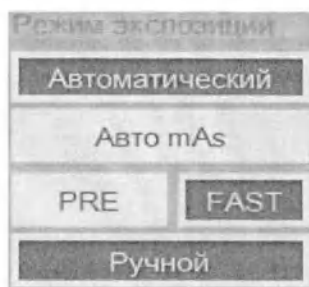
Рисунок 3.4.43 – Полуавтоматический режим экспозиции, подрежим PRE
