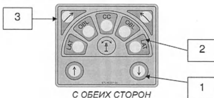
Рисунок 3.1.7 -Клавиатура движения С-дуги для версии моторизованного вращения
