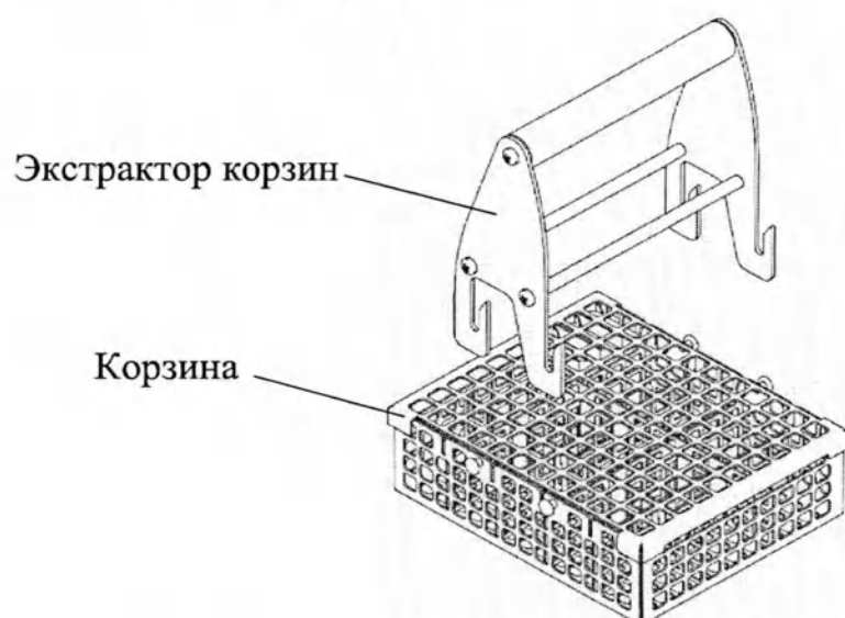
Рисунок 6.6 – Установка корзины посредством экстрактора варианта исполнения NX01.150
