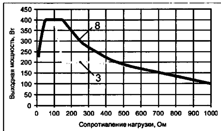
Рисунок А.38 – Зависимость выходной мощности от сопротивления нагрузки
