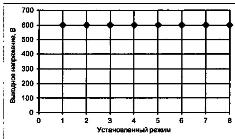
Рисунок А.42 – Зависимость максимального выходного напряжения от установленного эффекта
