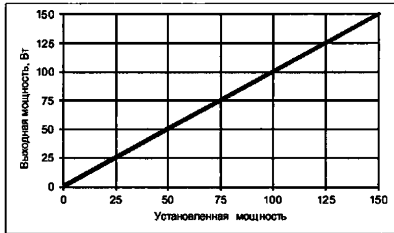
Рисунок А.46 – Зависимость выходной мощности от установленной мощности при номинальной нагрузке
