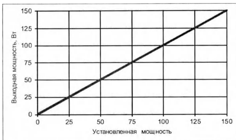
Рисунок А.49 – Зависимость выходной мощности от установленной мощности при номинальной нагрузке
