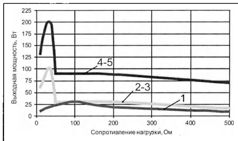
Рисунок А.52 – Зависимость выходной мощности от установленного режима при номинальной нагрузке
