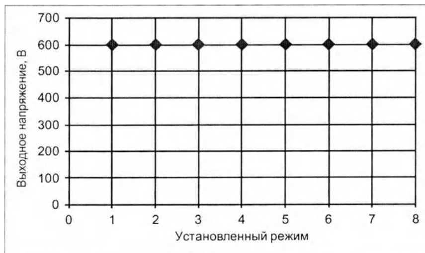
Рисунок А.45 – Зависимость максимального выходного напряжения от установленного эффекта
