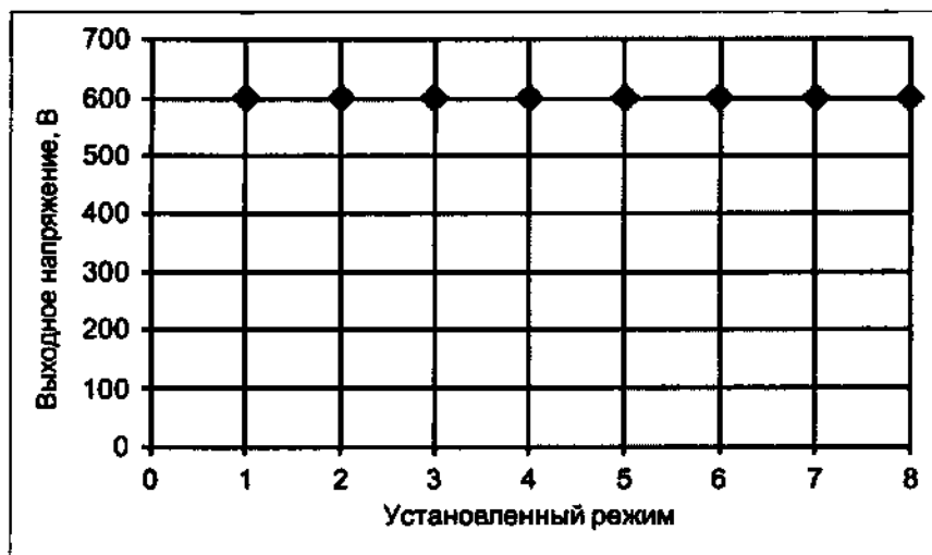
Рисунок А.39 – Зависимость максимального выходного напряжения от установленного эффекта
