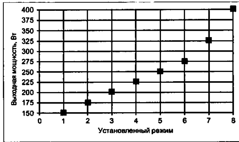
Рисунок А.43 – Зависимость выходной мощности от установленного эффекта при номинальной нагрузке
