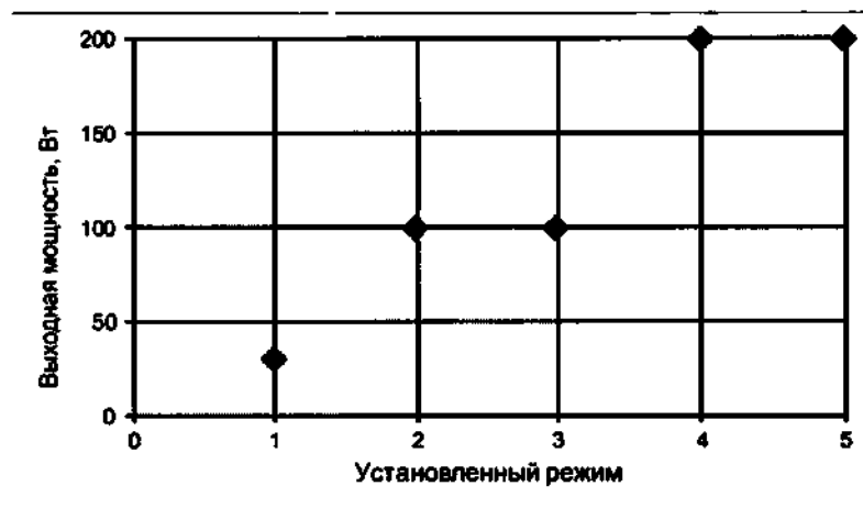
Рисунок А.52 – Зависимость выходной мощности от установленного режима при номинальной нагрузке
