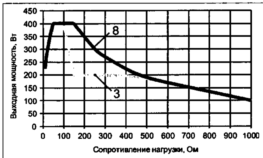
Рисунок А.44 – Зависимость выходной мощности от сопротивления нагрузки
