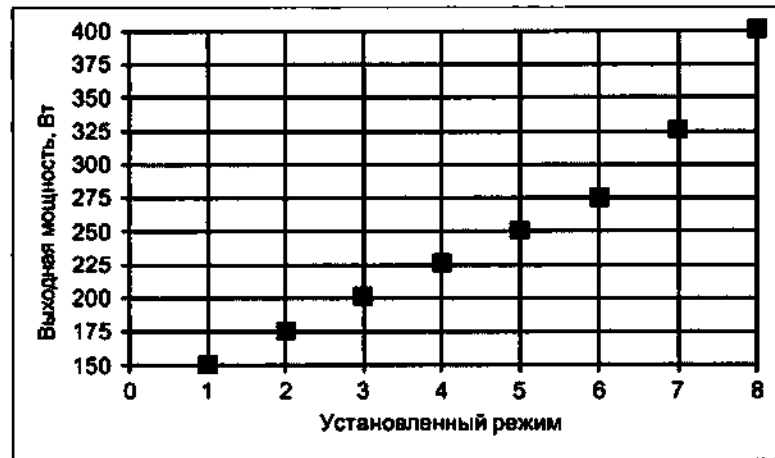
Рисунок А.37 – Зависимость выходной мощности от установленного эффекта при номинальной нагрузке
