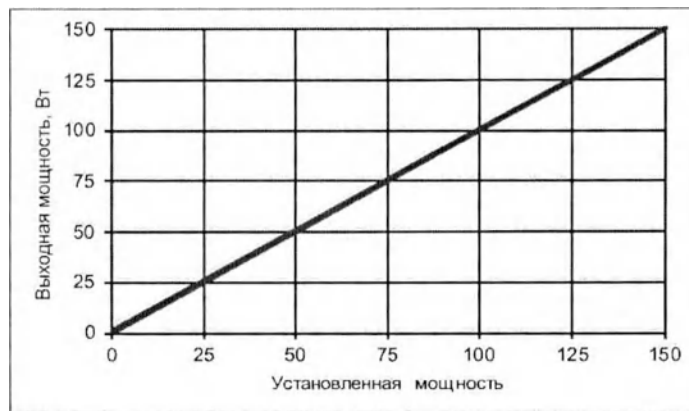
Рисунок А.7 – Зависимость выходной мощности от установленной мощности при номинальной нагрузке
