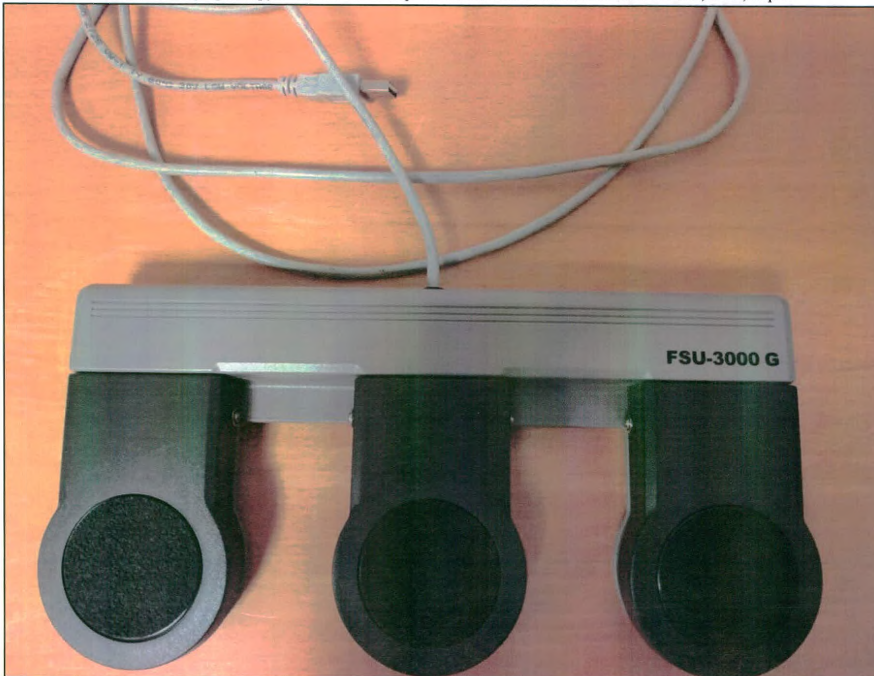
Переключатель педальный программируемый FSU-3000G, производства WHANAM ELECTRONICS CO., LTD., Корея
