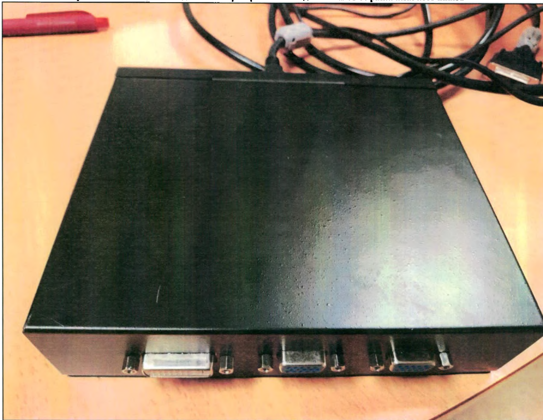
Сплиттер видеосигналов для объединения и преобразования видео сигналов от различных источников
