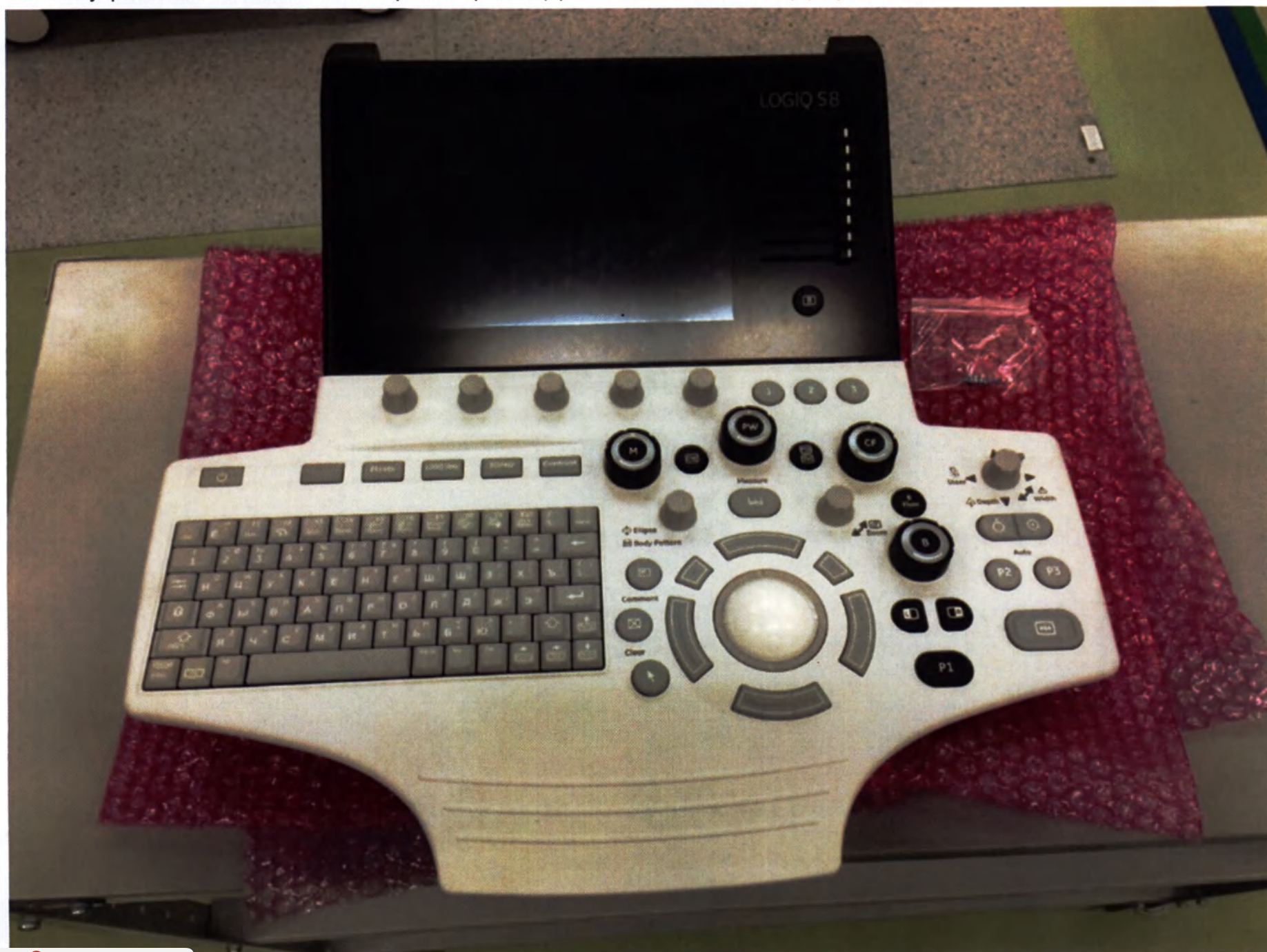
Панель управления с кнопками и сенсорным экраном (производство АО «МТЛ») (Версии: R4)
