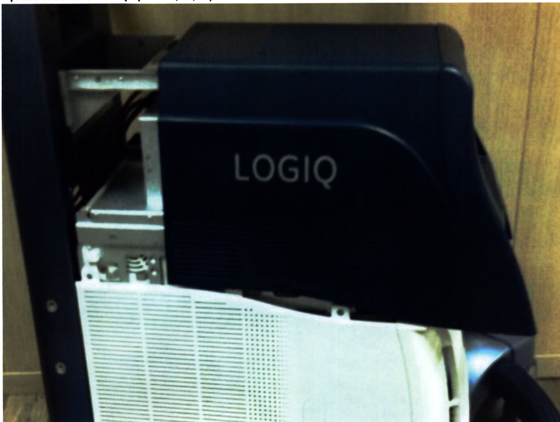
Крышка системного блока. (Версии: R2, R3, R4)
