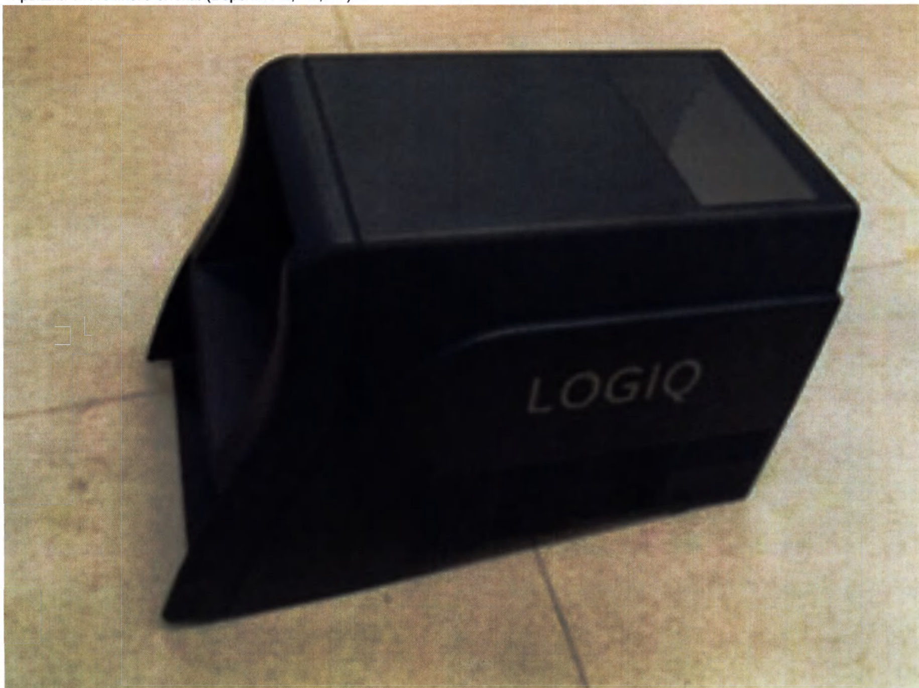
Крышка системного блока. (Версии: R2, R3, R4)
