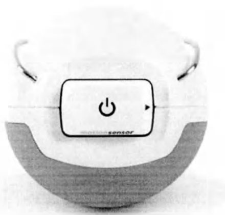
Рисунок 53. Правильное центрование датчика движения PABLO на манипуляторе PABLO Multiball
