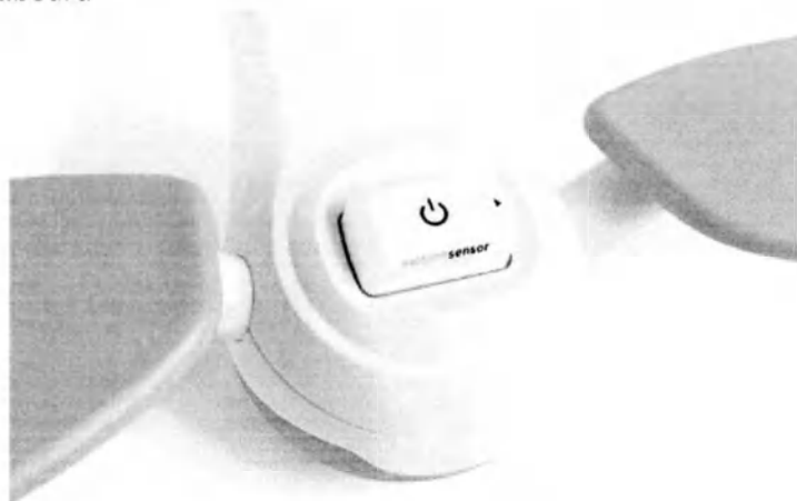
Рисунок 54. Правильное центрование датчика движения PABLO на манипуляторе PABLO Multiboard
