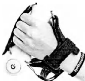
Рисунок 57. Присоединение устройства PABLO к руке
