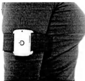
Рисунок 62. Правильное присоединение датчика движения PABLO
