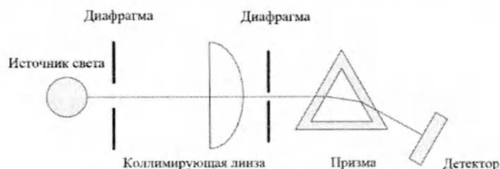
Рис. 4-1 Принципиальная схема измерения удельной плотности мочи методом рефрактометрии
