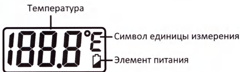
Рис. 4 – ЖК-дисплей термометров «Armed» DT001, DT007, DT008
