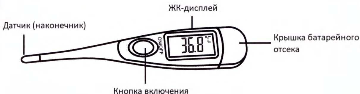
Рис. 1 – Основные элементы термометра «Armed» DT001
