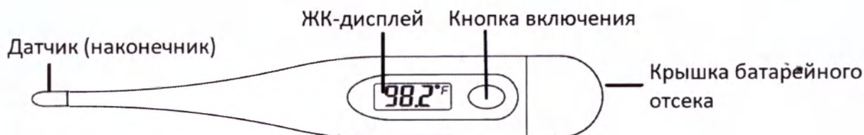
Рис. 3 – Основные элементы термометра «Armed» DT008
