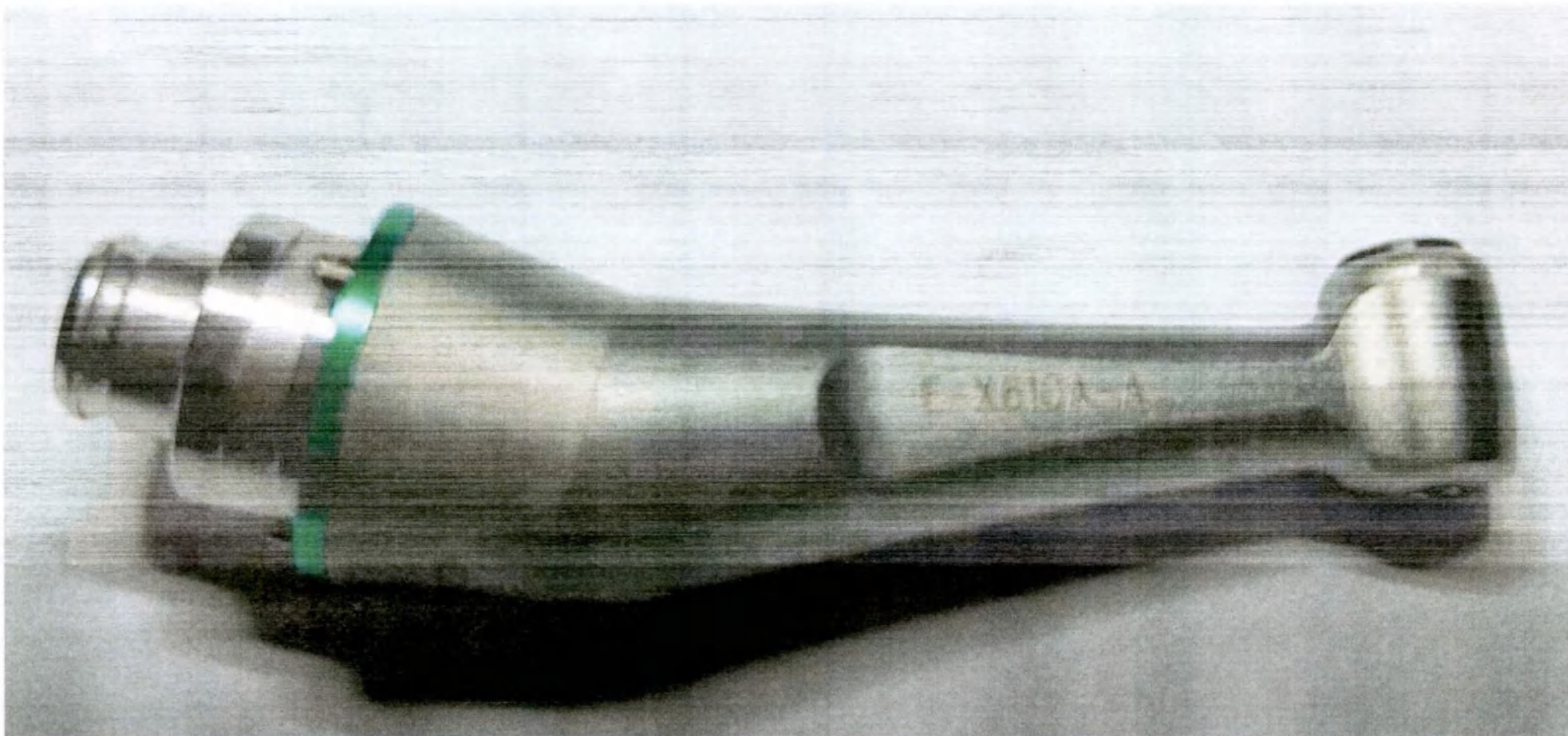
Фотографическое изображение 29 – Контругловой наконечник, модель E-X61CA-A (вид сбоку)
