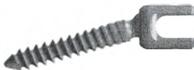
Рисунок А.76 - Винт полиаксиальный диаметрами 4.5 мм, 5.0 мм, 5.5 мм, 6.5 мм, 7.5 мм, 8.0 мм, 8.5 мм для транспедикулярной системы 6.0
