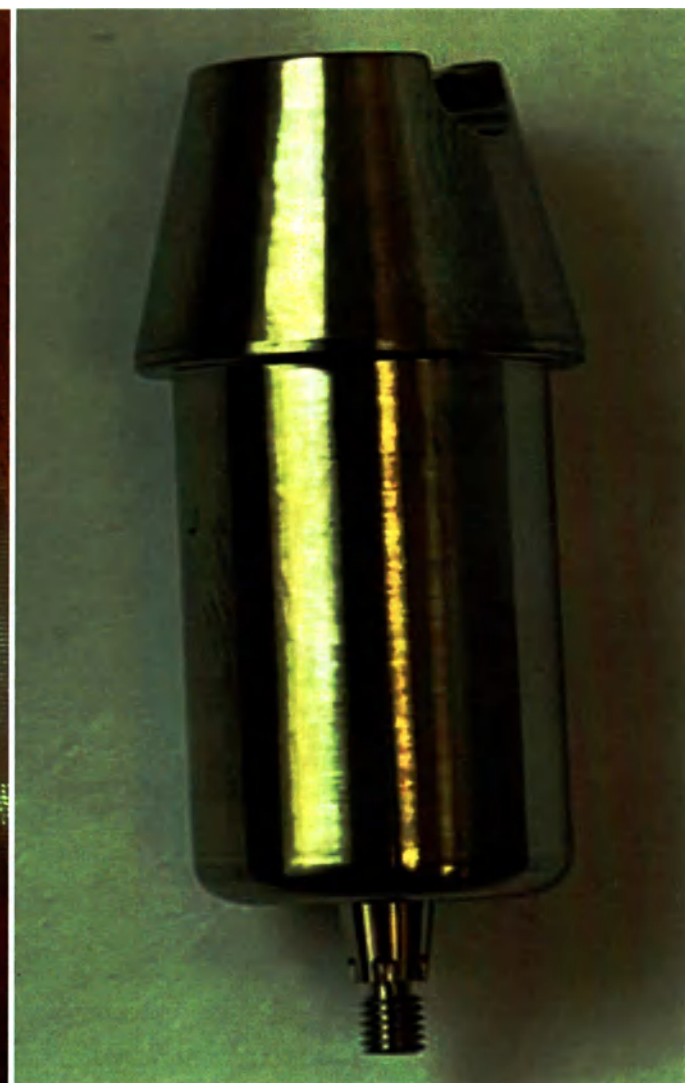
PRE-MILL ЗАГОТОВКА ТИТАНОВАЯ A2, с индексом, R (холдер ZirkonZahn)
