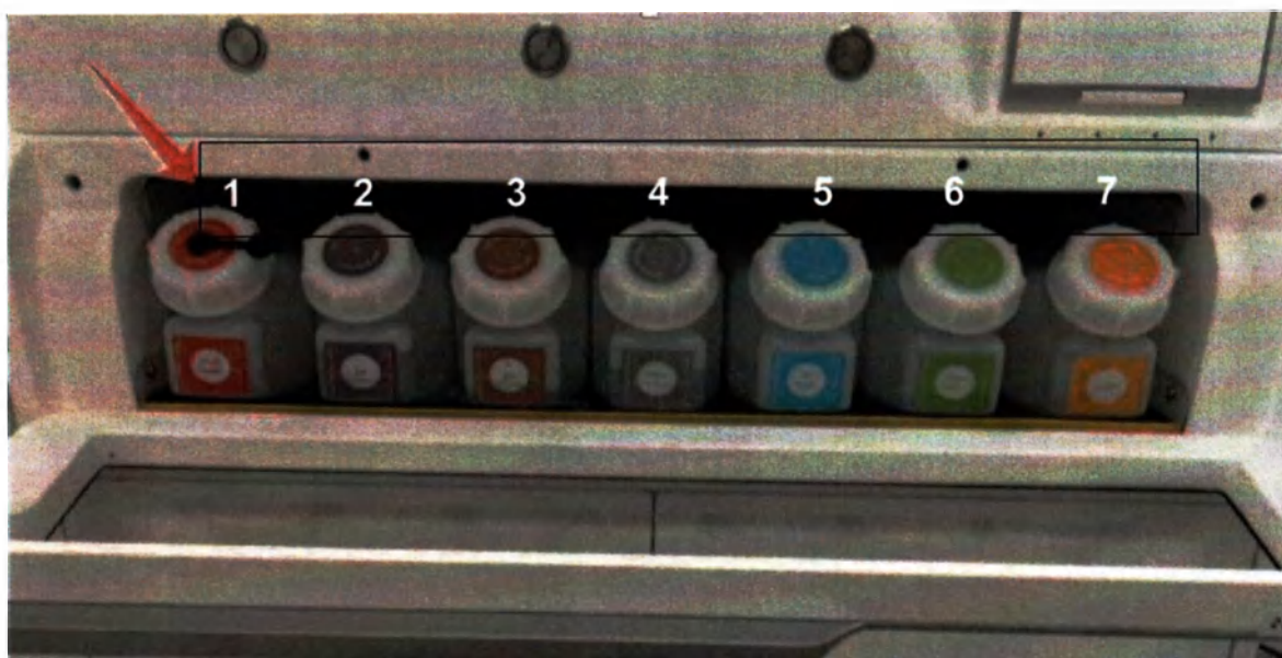
Рисунок 43. Модуль буферных растворов и модуль отходов иммуностейнера автоматического Dartmon AS330 PLUS. Стрелка указывает на бутылку для опасных отходов.
