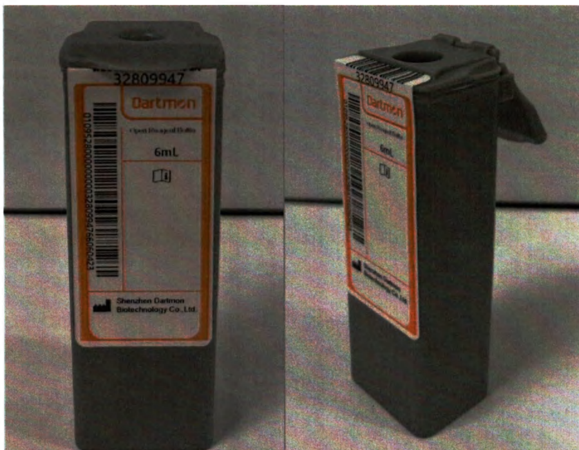
Рисунок 61. Флакон для реагентов для иммуностейнера Dartmon Open Reagent Bottle (6 мл)
