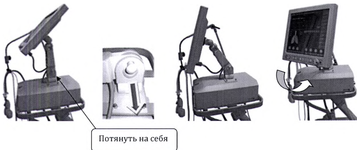
Рис. 5-2. Стопорная ручка и различные положения монитора.
