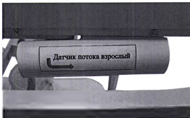
Рис. 5-12. Место положения защитного кожуха датчика потока.
