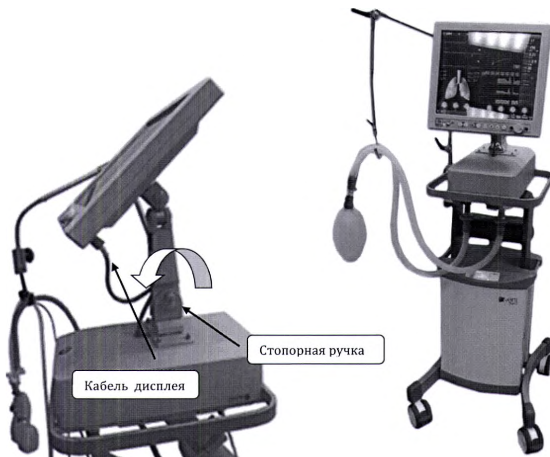
Рис. 5-1. Установка дисплея в рабочее положение.
