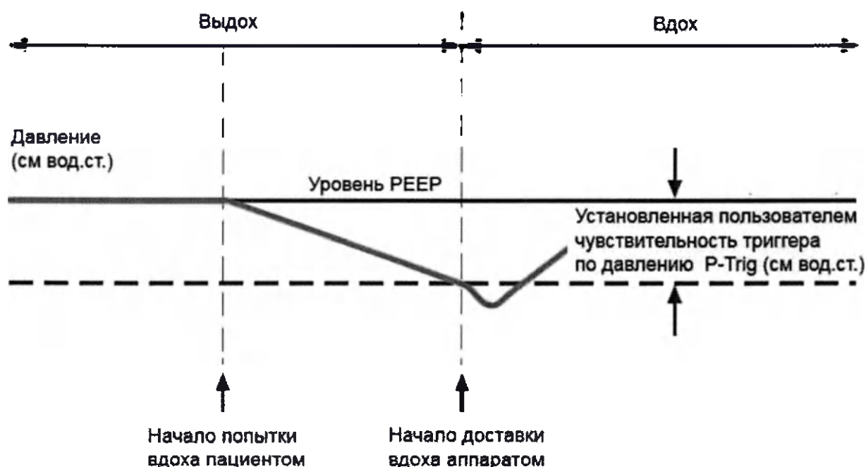
Рис. Пр1-2 Инициация вдоха с использованием триггера по давлению.
