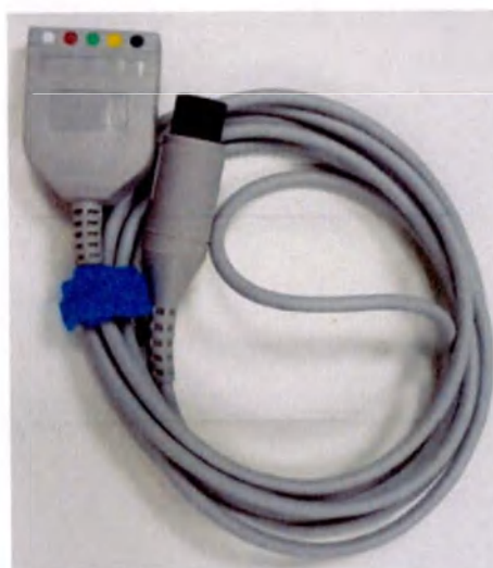
Рис. А5.3.4 Кабель ЭКГ на 5 отведений
