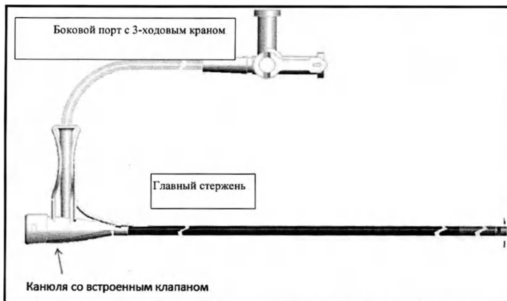
Рисунок 27. Конструкция катетера CPS Aim SL
