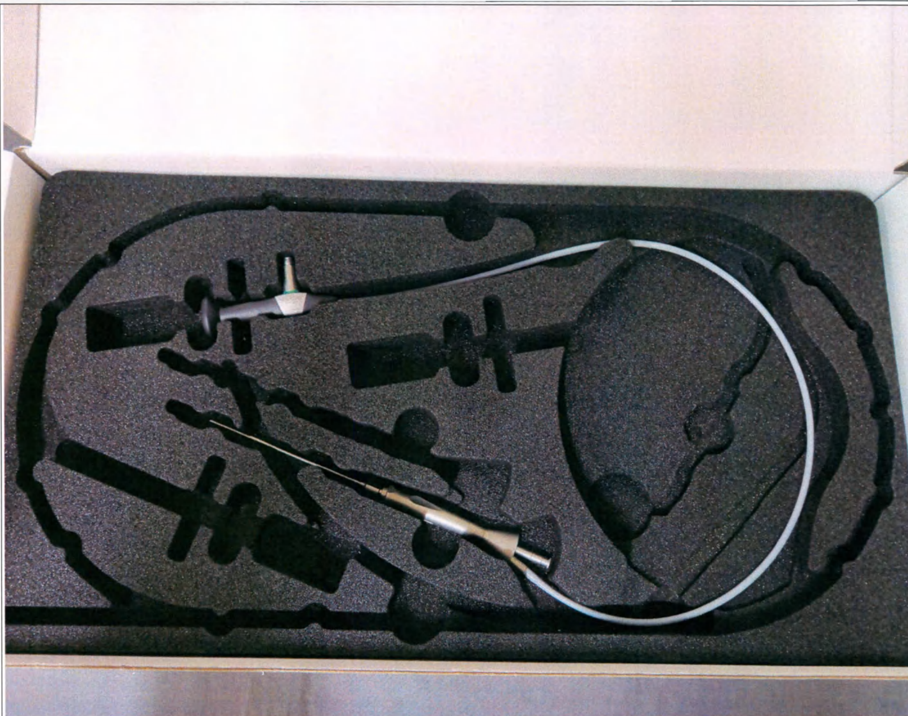
Рис. 1. Эндоскоп жесткий миниатюрный для сиаэндоскопии, с отклоненным дистальным концом, направление наблюдения 0^\circ , диаметр 0,9 мм, рабочая длина 12 см, длина 100 см
