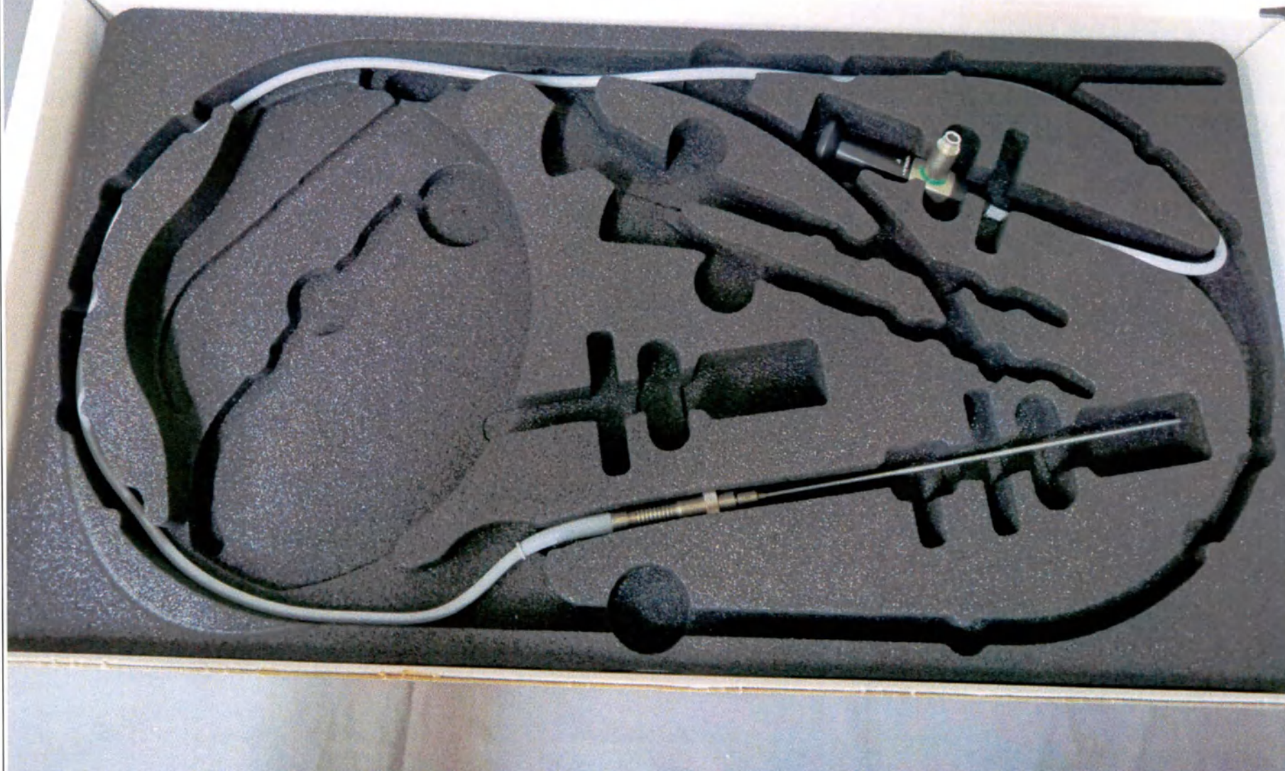
Рис. 11. Эндоскоп жесткий миниатюрный для сиалэндоскопии, с отклоненным дистальным концом, направление наблюдения 0^\circ , диаметр 1 мм, рабочая длина 16 см, длина 147 см
